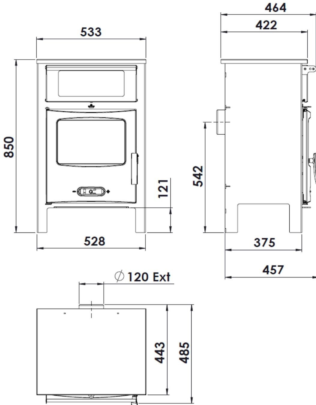
Figura n°3 - Dimensiones en mm del aparato Sagra CH
