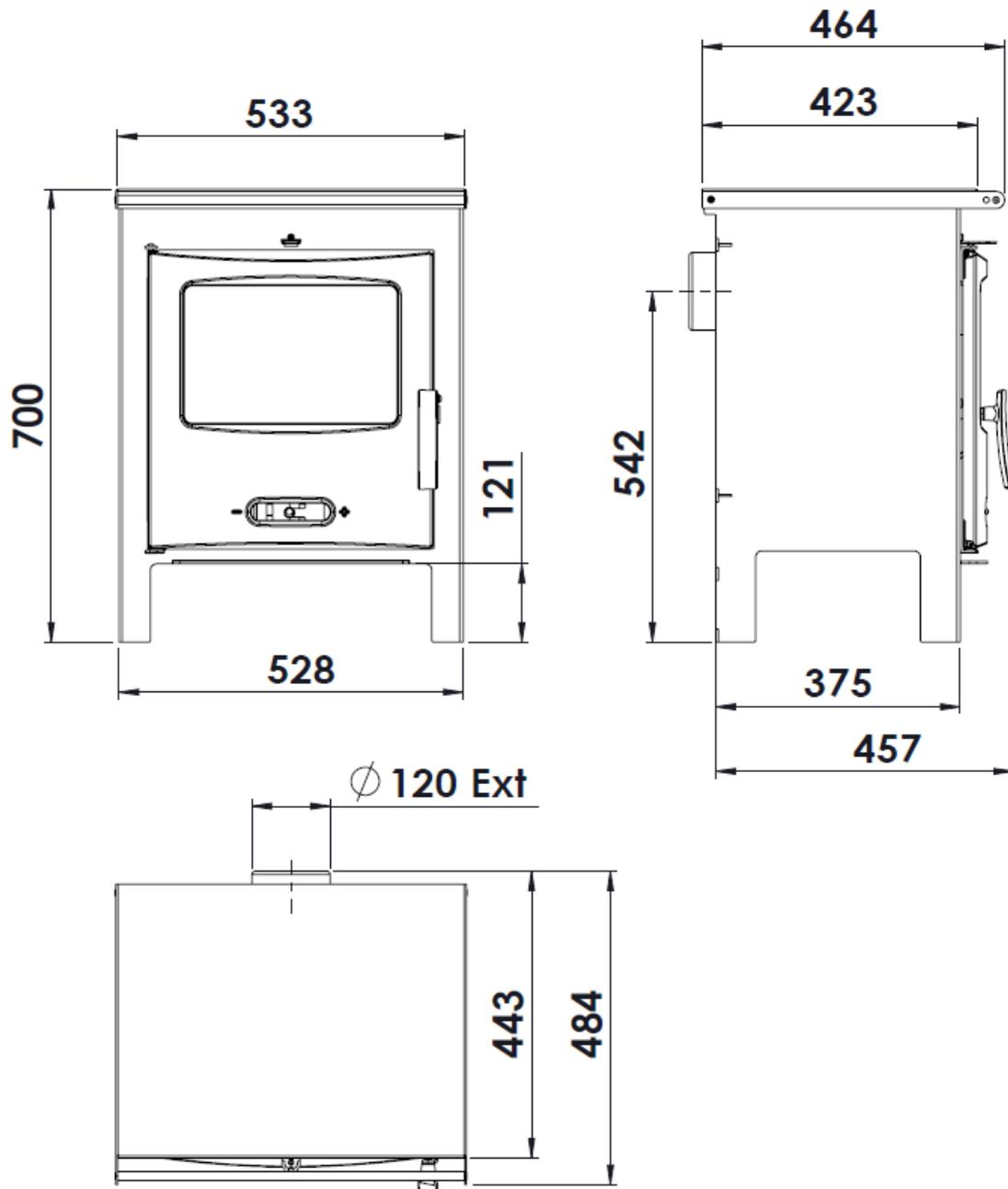
Figura nº2 - Dimensiones en mm del aparato Sagra CP
