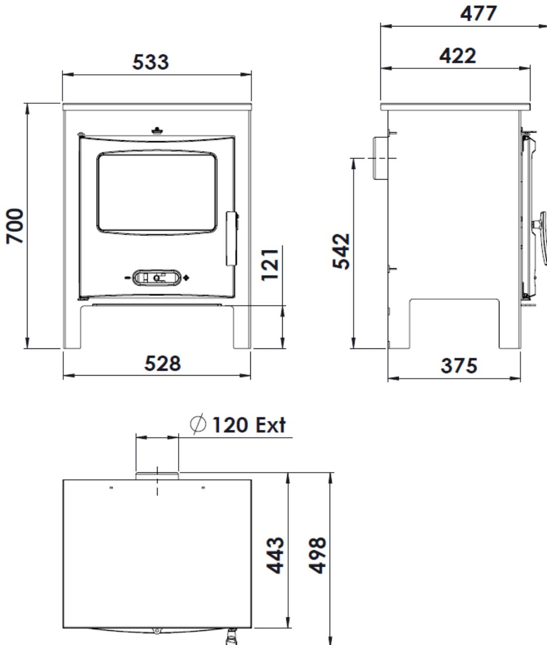
Figura n°1 - Dimensiones en mm del aparato Sagra
