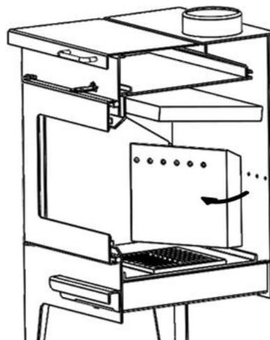
Figura n°14 - Extraer la vermiculita trasera derecha
