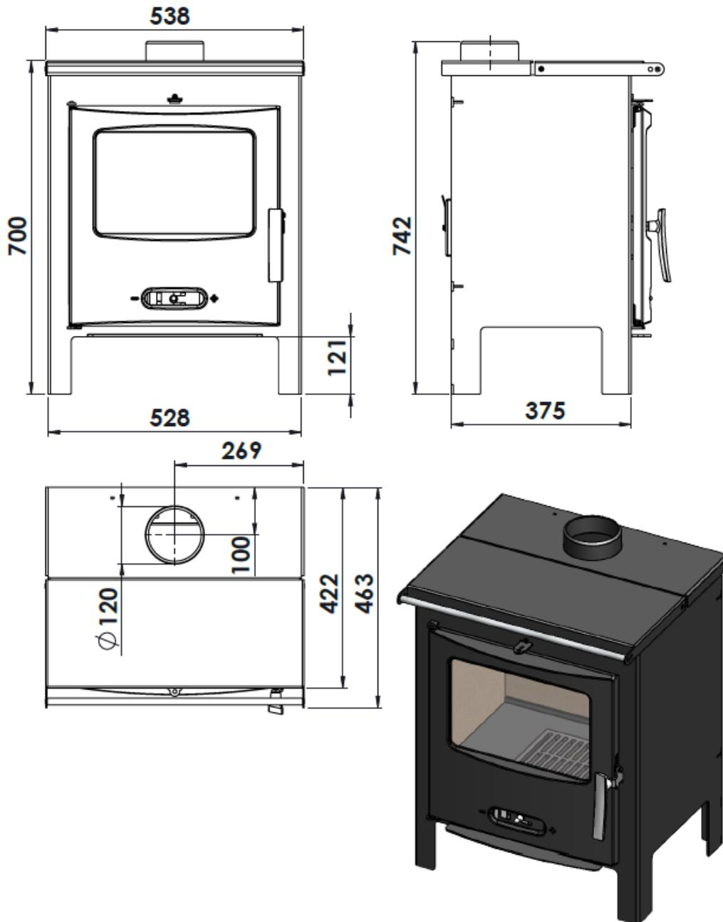
Figura nº2 - Dimensiones en mm del aparato Sagra CP
