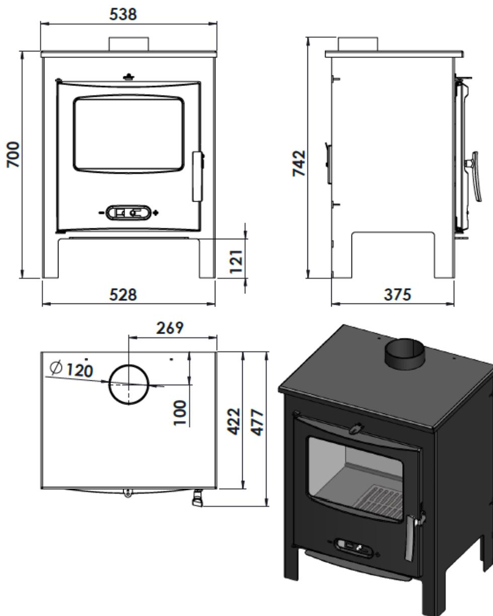
Figura n°1 - Dimensiones en mm del aparato Sagra
