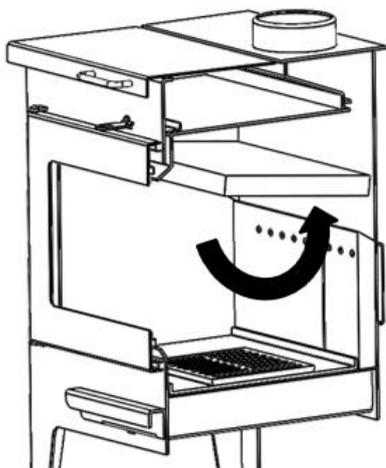
Figura n°11 - Girar el deflector hacia arriba por detrás y dejarlo elevado horizontalmente
