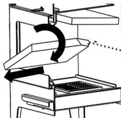
Figura n°15 - Abatir hacia el interior del hogar la vermiculita lateral izquierda y extraerla del hogar
