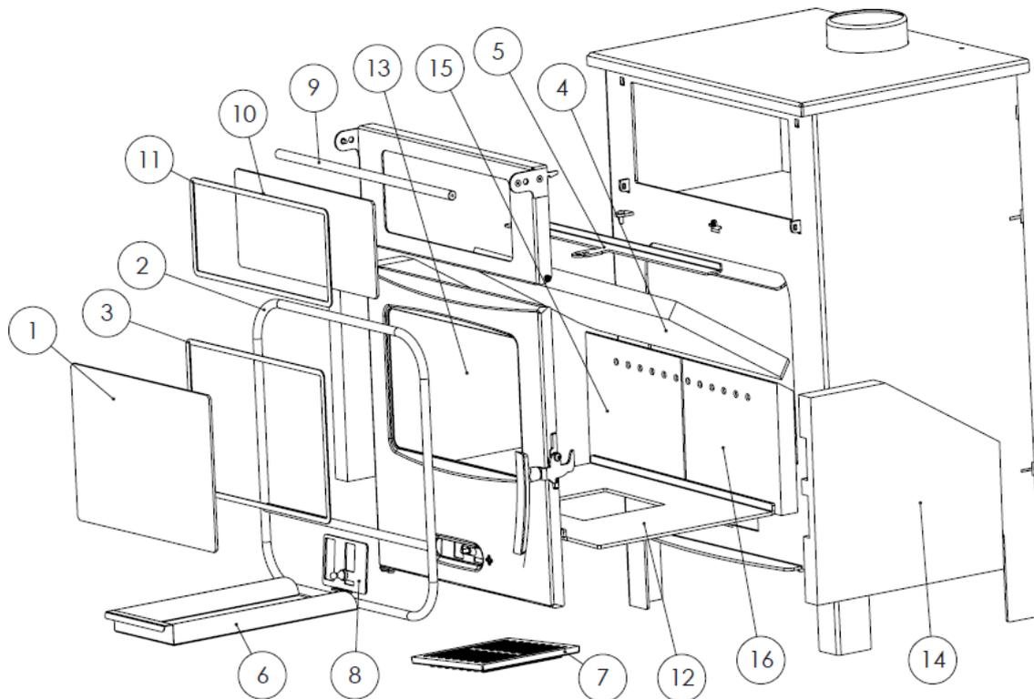
Figura nº19 - Explosionado Sagra CH
