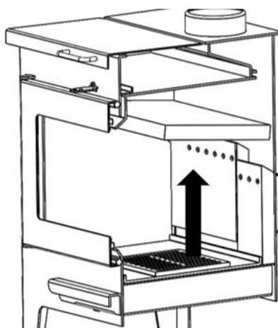
Figura n°12 - Elevar la vermiculita trasera izquierda
