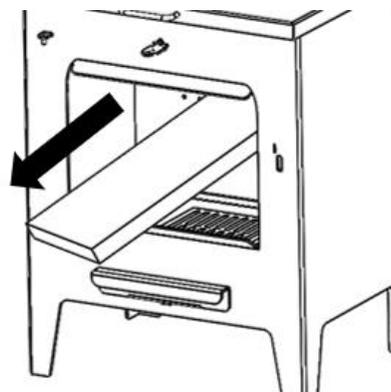
Figura n°16 - Extraer el deflector posicionándolo como en la imagen
