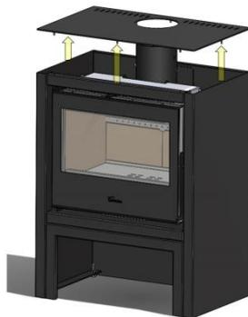
Figura nº5 - Levantar encimera (no tiene tornillos)
