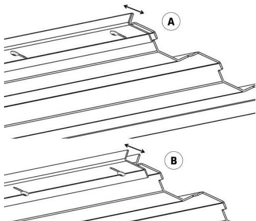
Figura n°18 - Diferentes posiciones del deflector inferior PLATINUM 800
