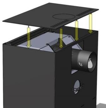
Figura n°11 - Colocar la encimera, por su propio peso sin tornillos
