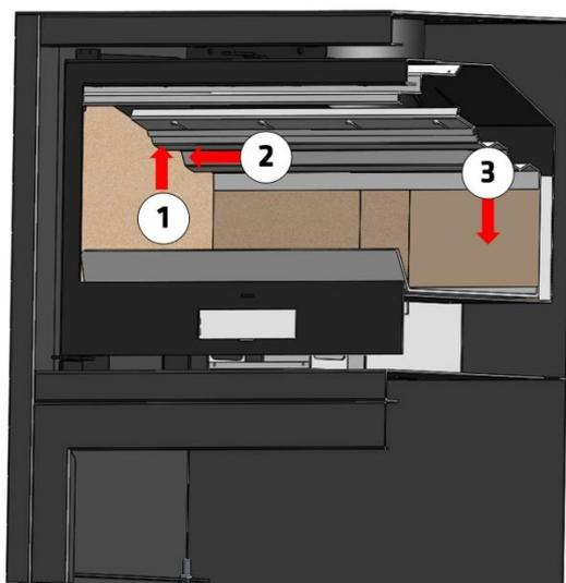
Figura n°19 - Desmontaje del deflector PLATINUM 800
