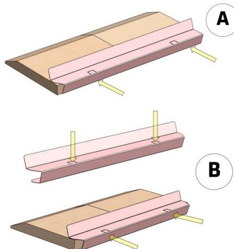
Figura n°20 - Diferentes posiciones del deflector inferior PLATINUM 600
