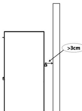
Figura n°12 - Separación entre el aparato y la pared trasera.
