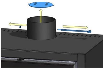
Figura nº4 - Desmontar clapeta
