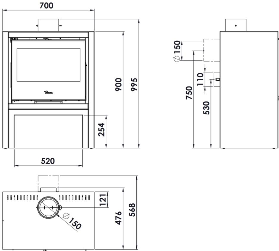
*Figura n°1 - Dimensiones en mm del aparato Platinum 600*
