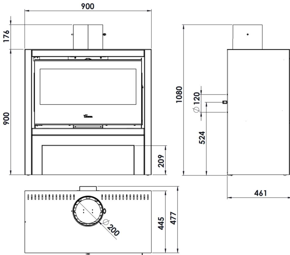
Figura n°2 - Dimensiones en mm del aparato Platinum 800
