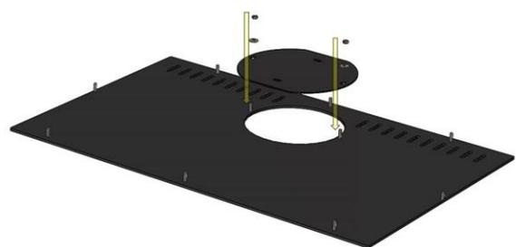
Figura nº10 - Montar el tapón de la encimera con tuercas y arandelas.
