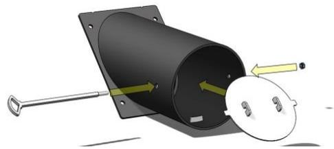
Figura nº8 - Montar la clapeta
