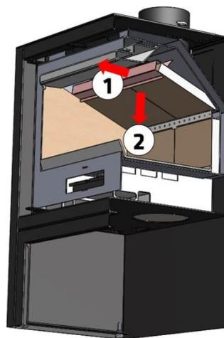
Figura n°21 - Desmontaje del deflector PLATINUM 600
