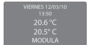
Cuando la temperatura ambiente supera la temperatura establecida de +3°C, el aparato se va apagando pasando a través de los estados de funcionamiento [Esp.St-by] y [Stand-by].
