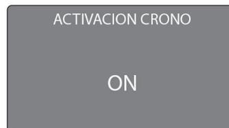
La activación de la modalidad cronotermostato [CRONO] queda confirmada cuando se enciende el led rojo al lado del botón [P1]. La activación de la modalidad [CRONO] ocurre únicamente si el aparato está activado (led verde en el panel de mandos encendido) y si la modalidad [CRONO] está activada (led rojo en el panel de mandos encendido).
