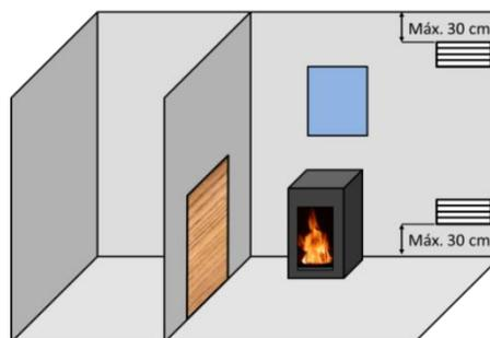
Figura n°2 - Esquema orientativo para rejillas de ventilación
