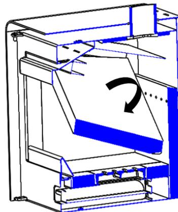
Figura nº12 - Extracción de los deflectores de vermiculita
