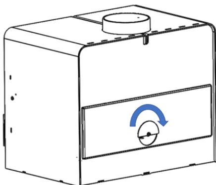
Figura nº9 - Registro de entrada aire doble combustión abierto
