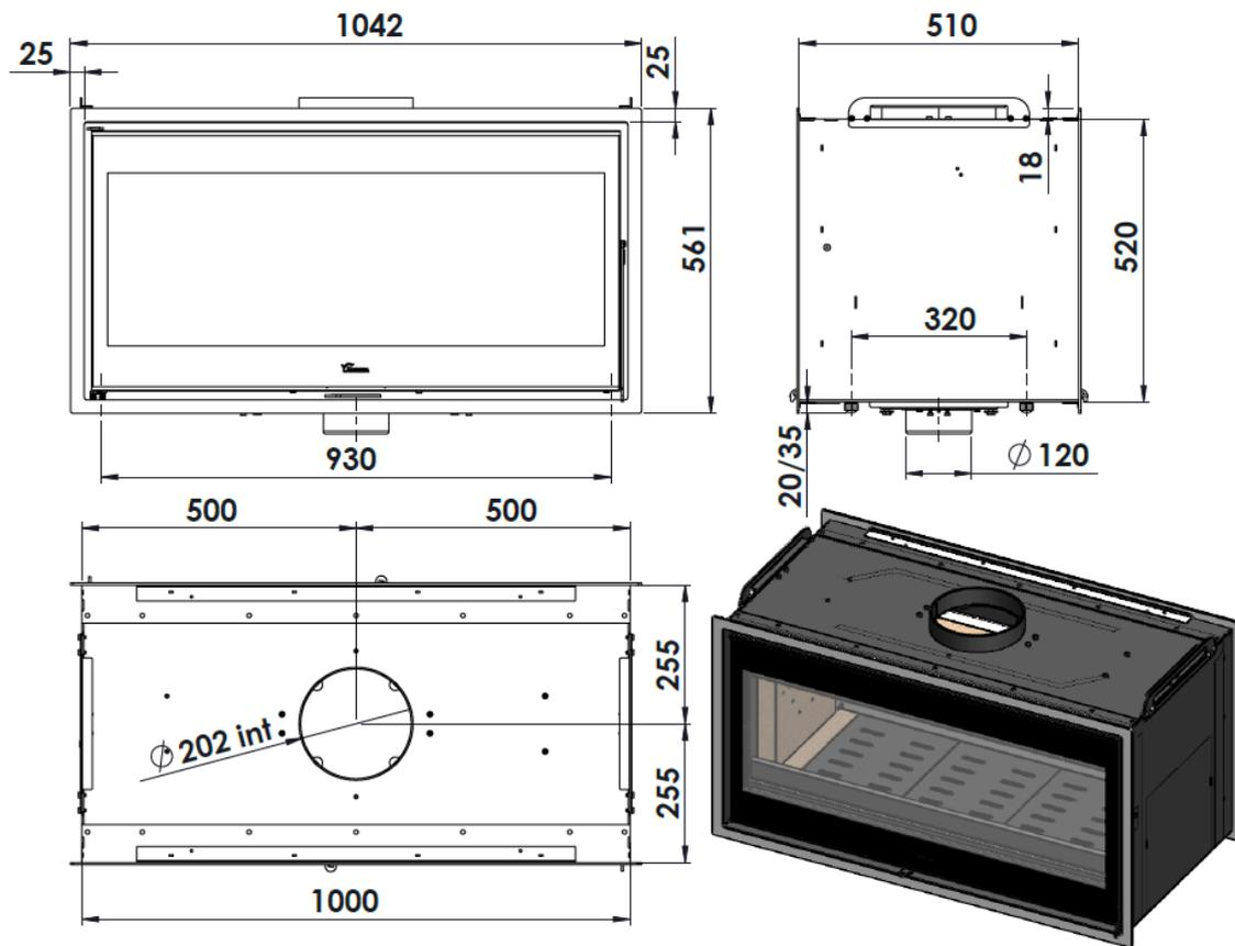
Figura nº3 - Dimensiones en mm del aparato Nickel 1000
