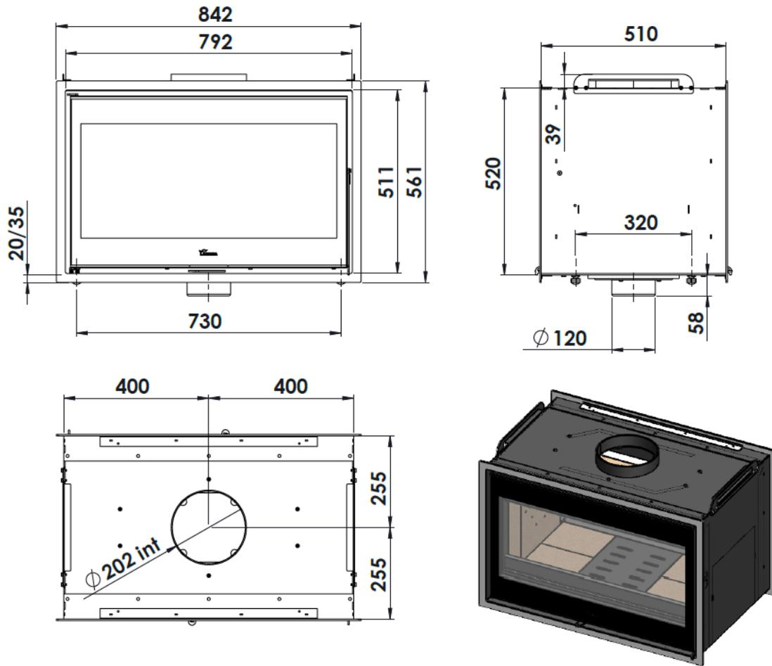
Figura n°2 - Dimensiones en mm del aparato Nickel 800
