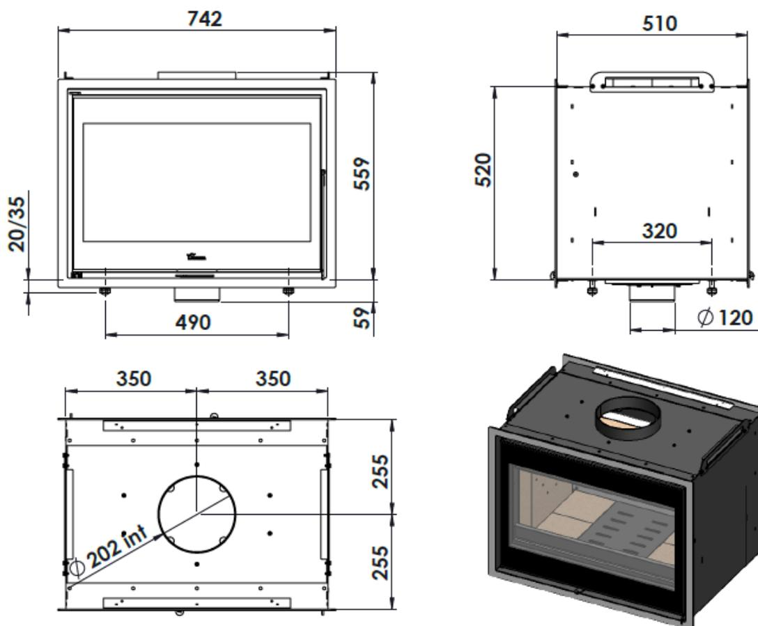
Figura nº1 - Dimensiones en mm del aparato Nickel 700
