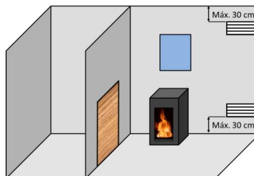
Figura n°4 - Esquema orientativo para rejillas de ventilación
