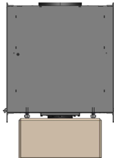
*Figura nº6 - El aparato tiene que ir sobre una Bancada para permitir el paso del aire para la combustión.*
