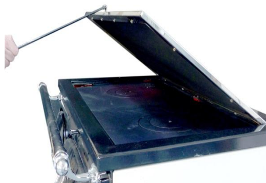
Figura nº15 - Acompañamiento del movimiento con el gancho
