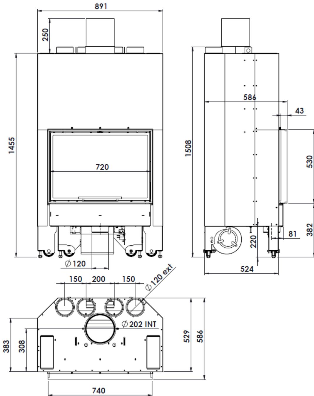
Figura n°1 - Dimensiones en mm del aparato ITACA 80 eco
