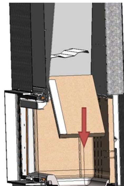
Figura n°34 - Desmontaje del deflector inferior Itaca 100 y 120 eco
