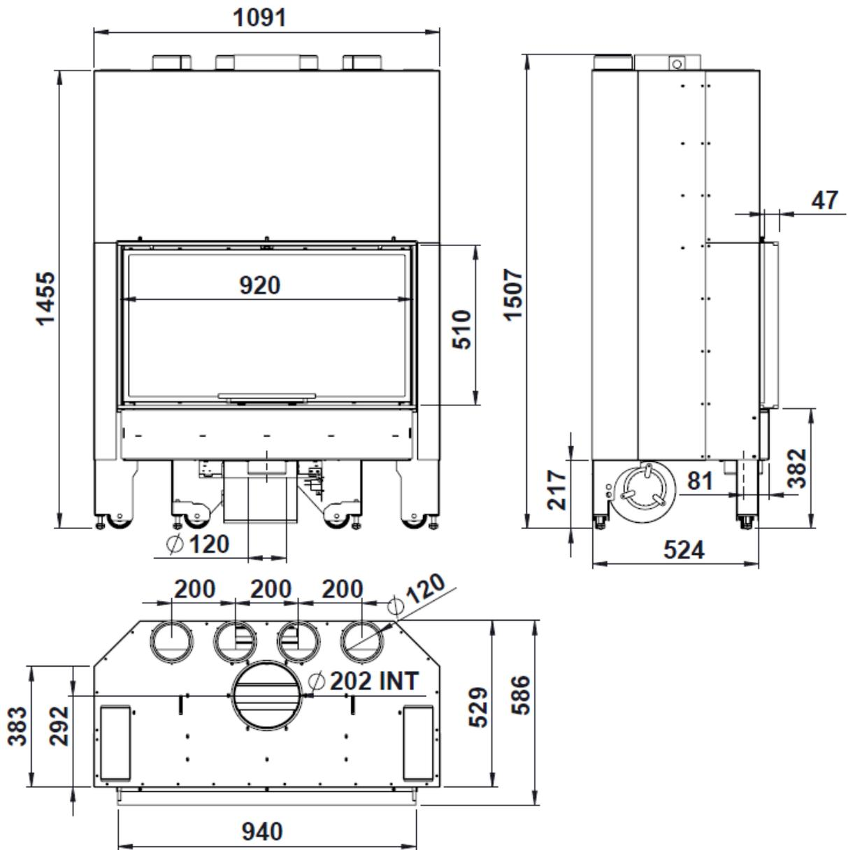
Figura n°2 - Dimensiones en mm aparato Itaca 100 eco
