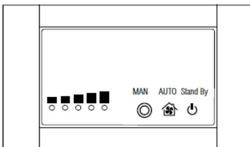
*Figura n°16 - Controlador del regulador de aire automático ELX AIR POWER-TRA*
