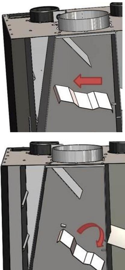
Figura n°33 - Desmontaje del deflector superior Itaca 80
