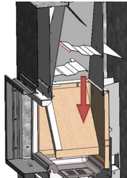
*Figura n°31 - Desmontaje del deflector inferior Itaca 80 eco*
