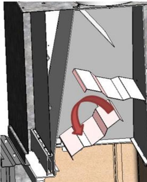
Figura n°32 - Desmontaje del deflector medio Itaca 80
