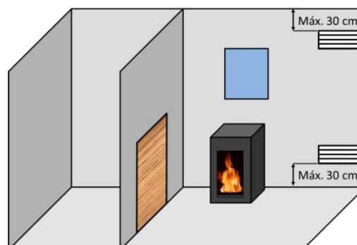
Figura nº4 - Esquema orientativo para rejillas de ventilación
