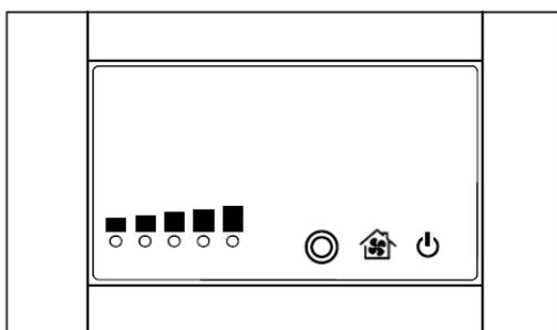
*Figura n°46 - Display regulador de aire automático/manual Itaca eco*
