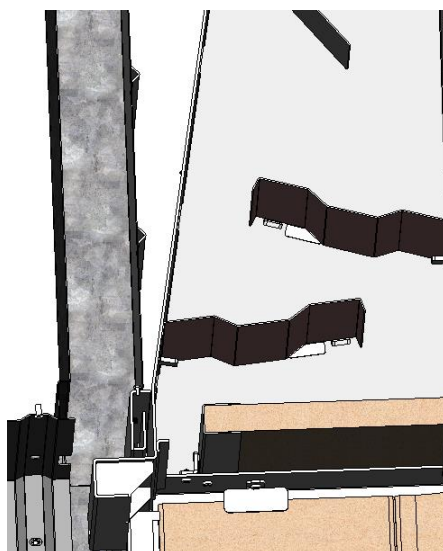
Figura n°29 - Vista de sección Itaca 80 eco con los deflectores colocados
