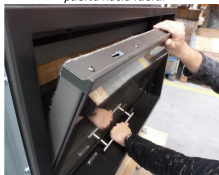
Figura n°41 - Sujetamos la puerta firmemente con ambas manos mientras la abatimos
