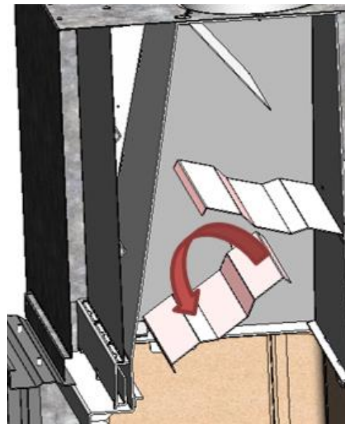
Figura nº32 - Desmontaje del deflector medio Itaca 80
