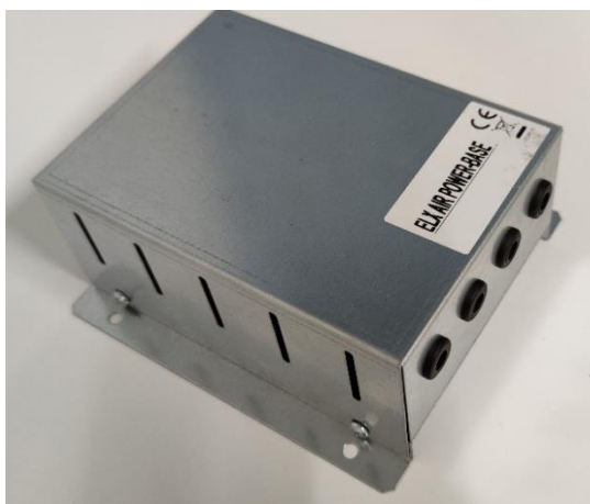
Figura nº14 - Módulo de potencia del regulador de aire automático ELX AIR POWER.
