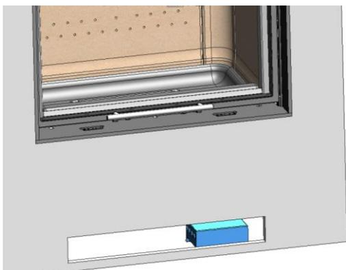
*Figura n°15 - Posicionamiento del módulo de potencia frente a la rejilla de ventilación frontal*
