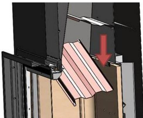
Figura n°25 - Desmontaje del deflector inferior Inca
