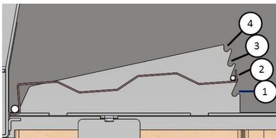
Figura n°24 - Diferentes posiciones del deflector inferior Inca
