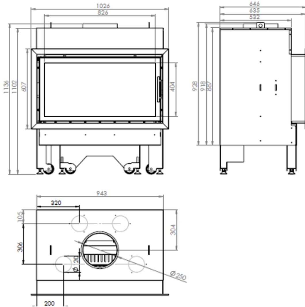
Figura n°2 - Dimensiones en mm aparato Inca 100
