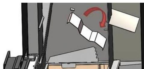
Figura n°26 - Desmontaje del deflector medio Inca
