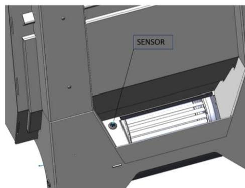
*Figura n°17 - Posición de la sonda de temperatura (SENSOR) en la salida de aire de la turbina*
