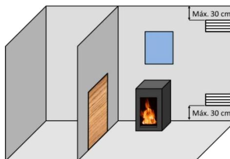
Figura nº3 - Esquema orientativo para rejillas de ventilación
