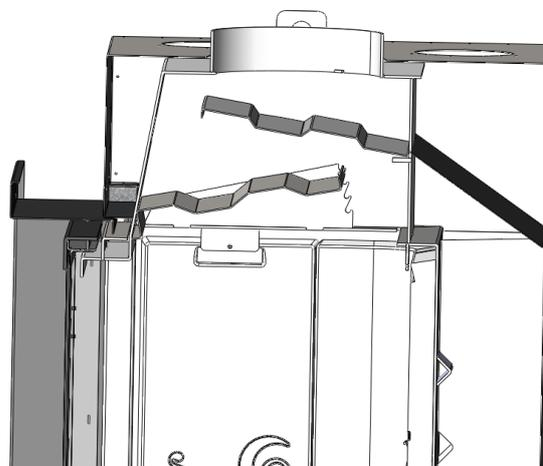
Figura nº23 - Vista de sección con los 2 deflectores colocados
