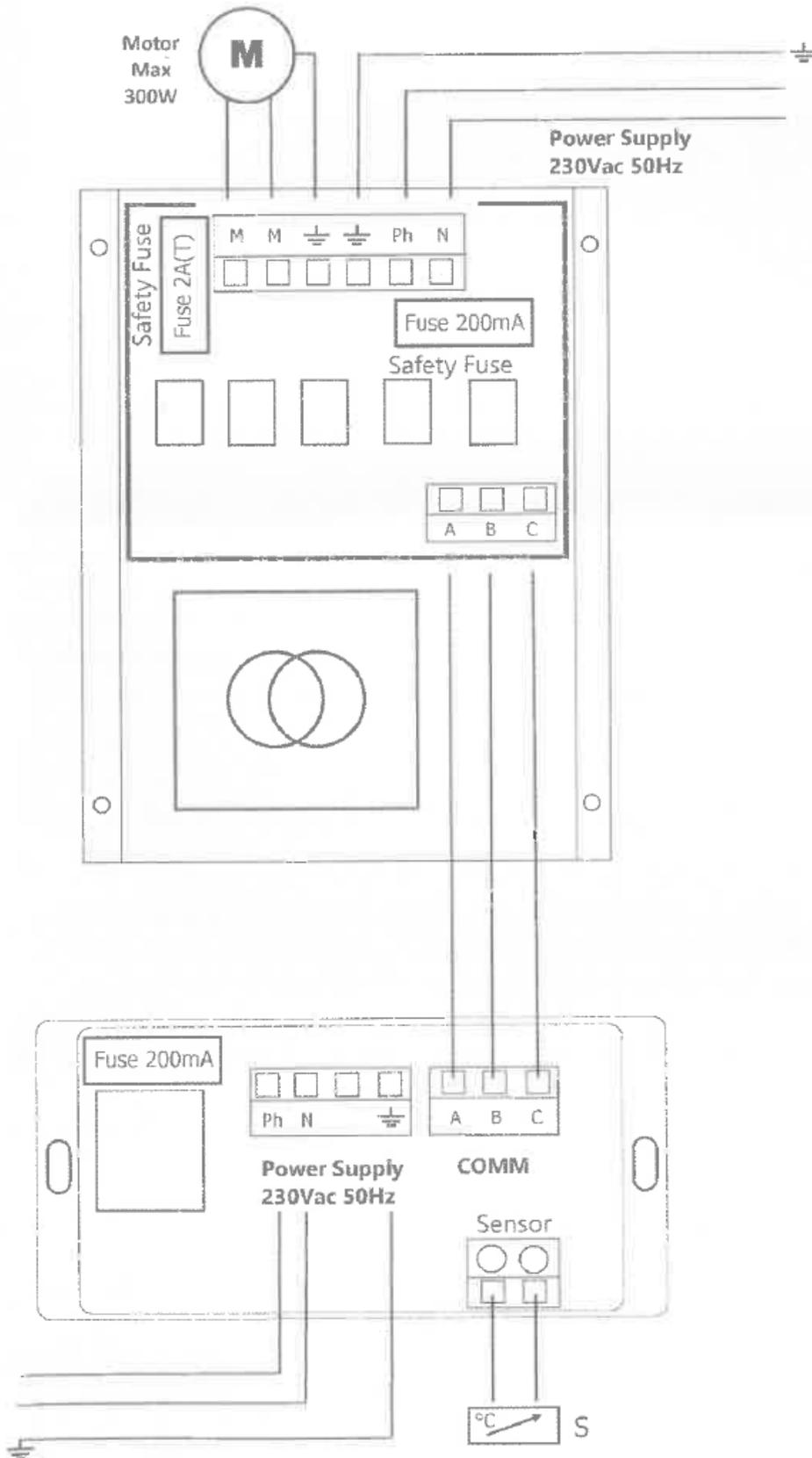
Figura n°13 - Conexiones a realizar en controlador y el módulo de potencia de la Inca C/V
