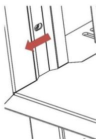
Figura n°11 - Extracción del marco
