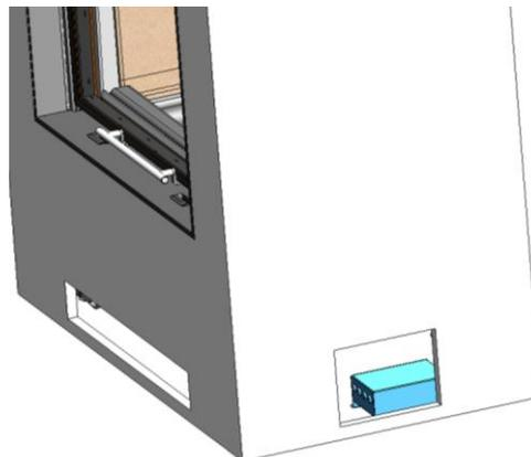
*Figura n°16 - Posicionamiento del módulo de potencia frente a la rejilla de ventilación lateral*
