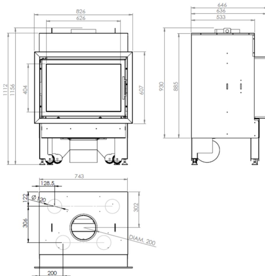
Figura nº1 - Dimensiones en mm del aparato INCA 80
