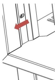
Figura nº11 - Extracción del marco
