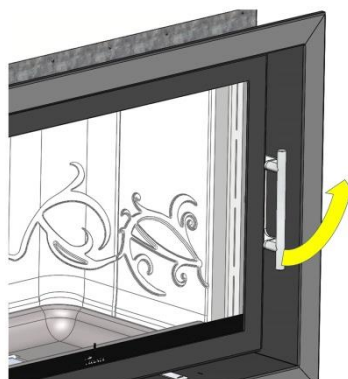
Figura nº22 - Apertura de la puerta Inca
