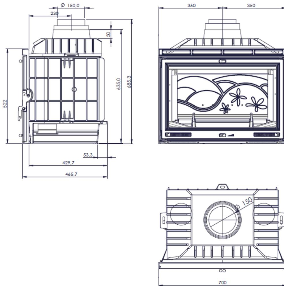
Figura n°2 - Dimensiones en mm del aparato RE-700/NEPAL
