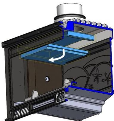
Figura n°14 - Extraer a la vez la otra mitad del deflector de vermiculita y el deflector de chapa
