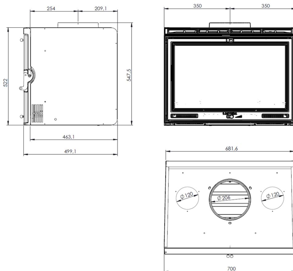
Figura n°1 - Dimensiones en mm del aparato IN-700/INDIA
