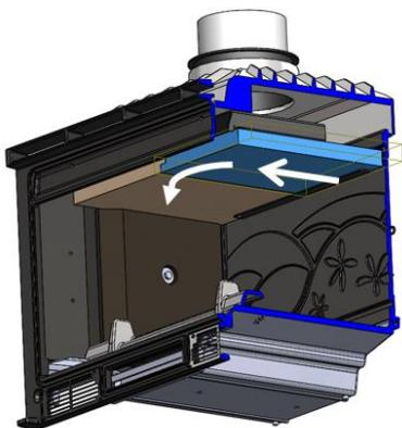
Figura n°13 - Traer hacia el frente e inclinar una mitad del deflector de vermiculita para extraerla
