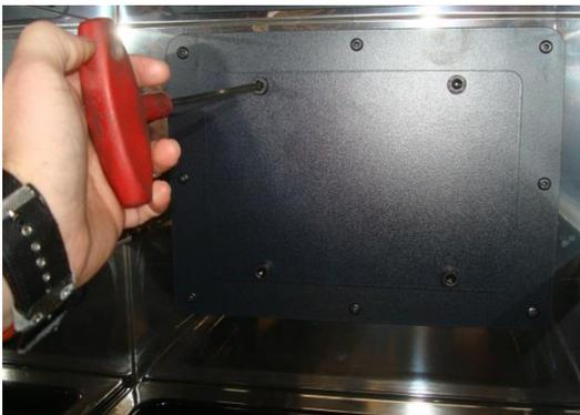
*Figura nº23 - Acceso a los tornillos para retirar la tapa de la escotilla*
