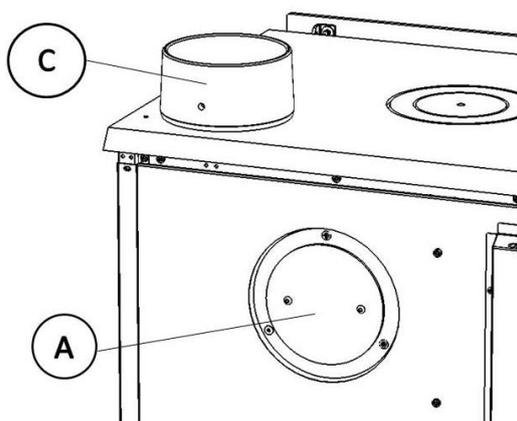
*Figura nº7 - Esquema para salida de humos superior*
