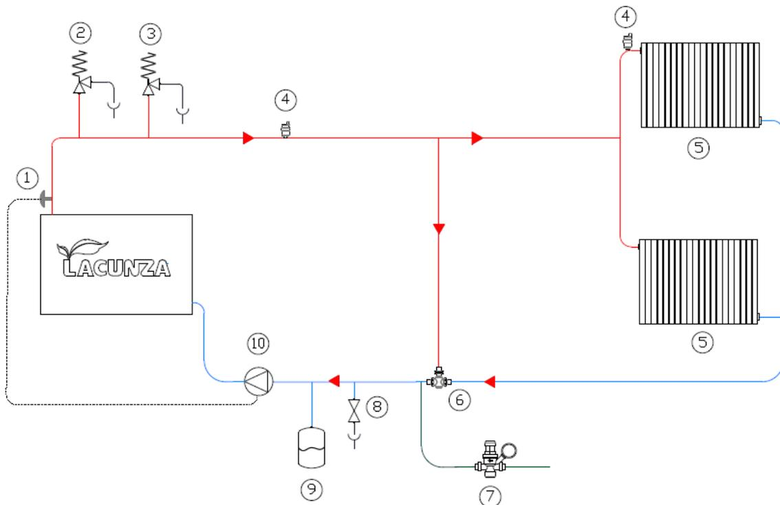
Cuando el agua de la paila alcance los 50°C el termostato (1) hará funcionar la bomba circulatoria (10), hasta que la temperatura del agua descienda de dicha temperatura.
