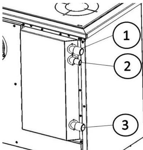
Figura nº12 - Racores de conexión en la paila
