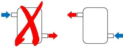
Figura nº11 - Conexión incorrecta (izda.) y conexión correcta (dcha.)
