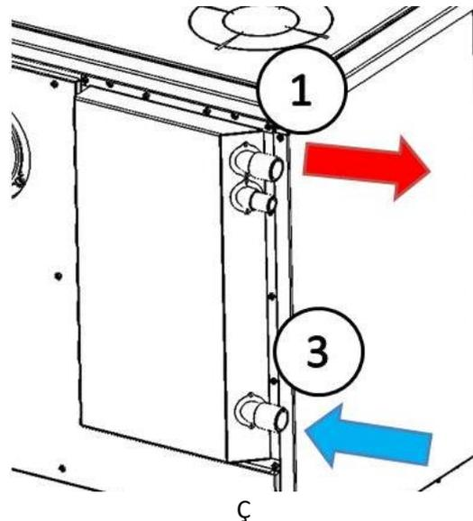
Figura nº13 - Conexiones 1: IDA, 3:RETORNO
