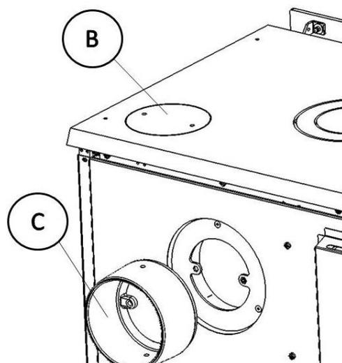
*Figura n°6 - Esquema para salida de humos trasera*
