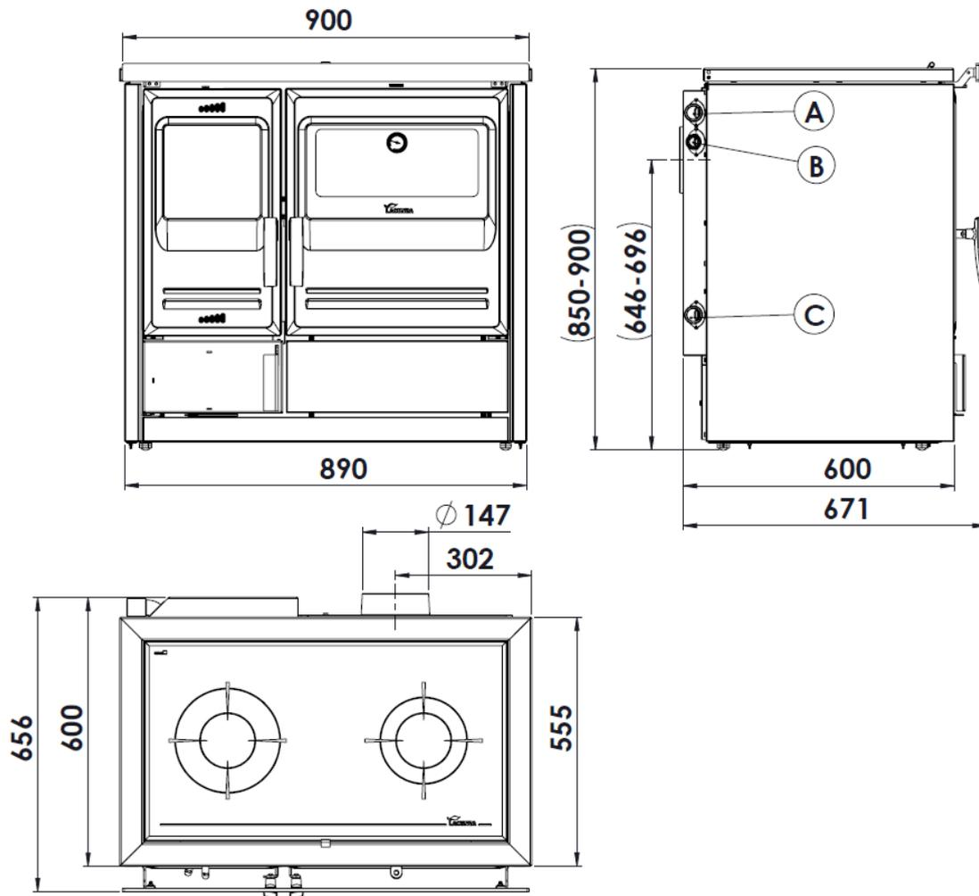
Figura nº2 - Dimensiones en mm del aparato ETNA 7T E3 Salida trasera
