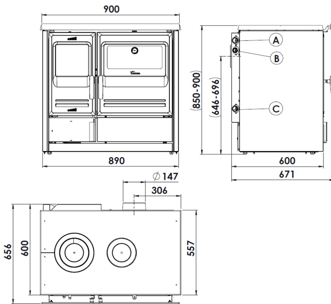
Figura nº1 - Dimensiones en mm del aparato ETNA 7T E3 Salida trasera
