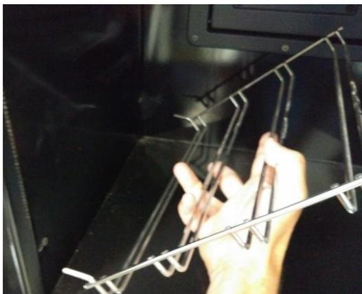
*Figura nº25 - Retirada de los soportes de varillas.*
