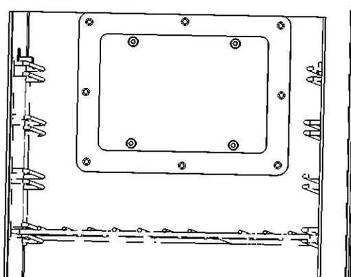
Figura nº19 - Escotilla de la parte trasera del horno
