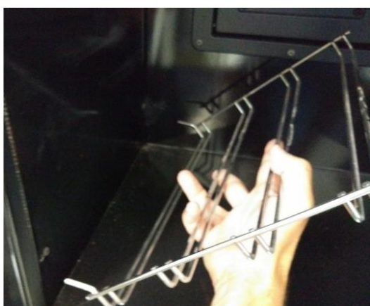
Figura nº23 - Retirada de los soportes de varillas.
