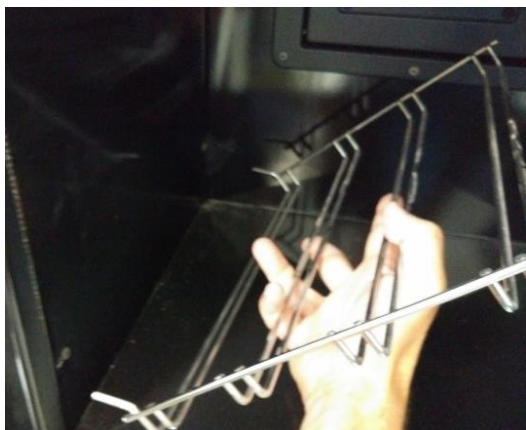
Figura n°21 - Retirada de los soportes de varillas.
