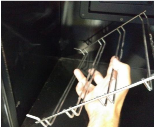
Figura nº22 - Retirada de los soportes de varillas.
