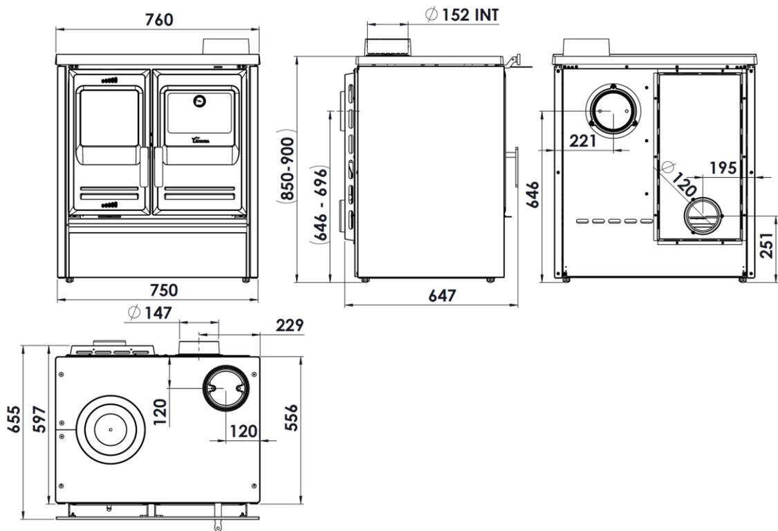
Figura nº1 - Dimensiones en mm del aparato ETNA 5T Salida SUP y Trasera
