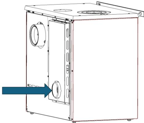
Figura nº11 - Conducción aire para cámara de combustión.
