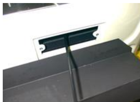
Figura nº18 - Accesos para la limpieza de la salida de humos.
