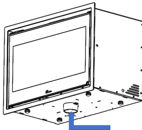
*Figura n°8 - Conducción de aire para cámara de combustión*
