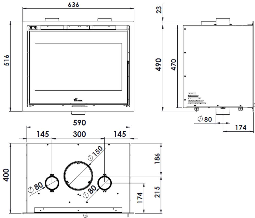
Figura n°2 - Dimensiones en mm del aparato ADOUR 600
