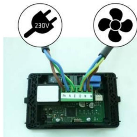
Figura nº15 - Conexiones a realizar en el potenciómetro
