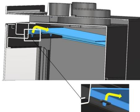
Figura nº23 - Desmontaje del deflector de chapa superior.
