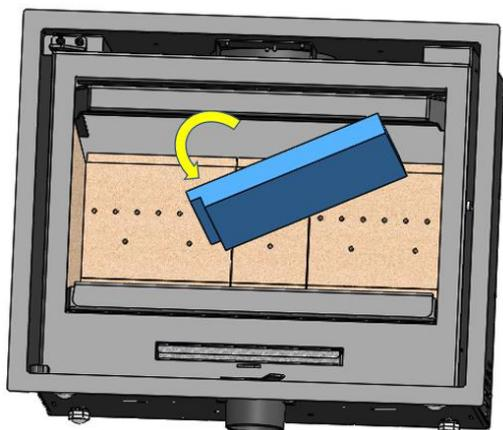
Figura nº22 - Desmontaje de los deflectores inferiores de vermiculita.
