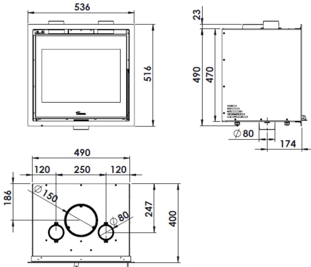
Figura n°1 - Dimensiones en mm del aparato ADOUR 500
