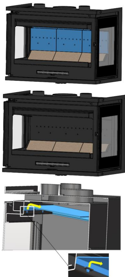
Figura n°29 - Desmontaje del deflector de chapa superior.
