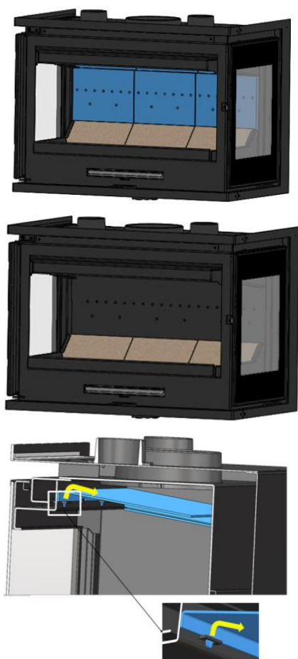
Figura n°29 - Desmontaje del deflector de chapa superior.
