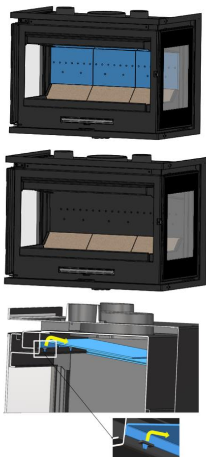
Figura n°29 - Desmontaje del deflector de chapa superior.
