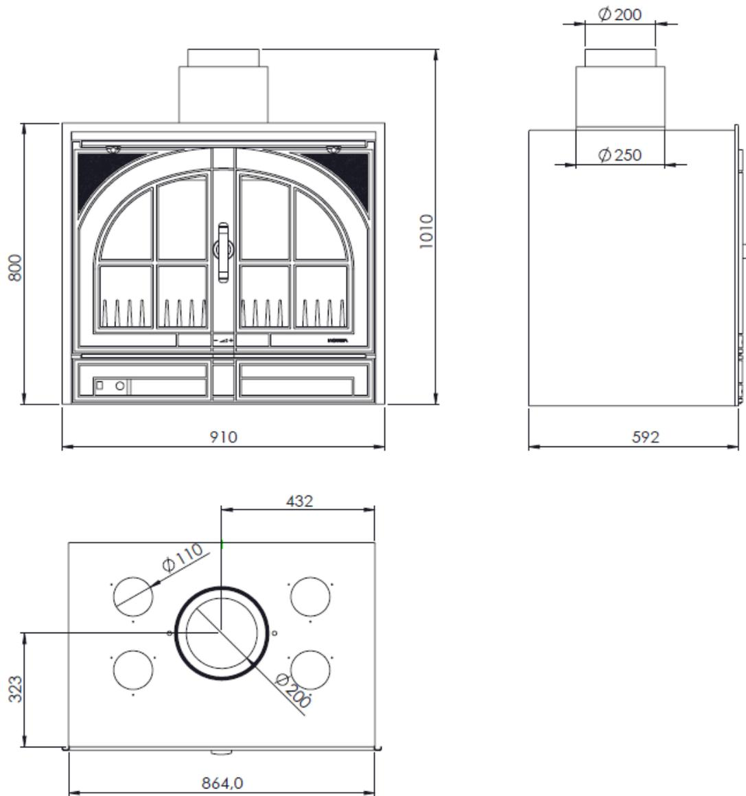
Figura n°2 - Dimensiones en mm del aparato Abodi
