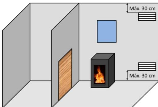
*Figura nº3 - Esquema orientativo para rejillas de ventilación*
