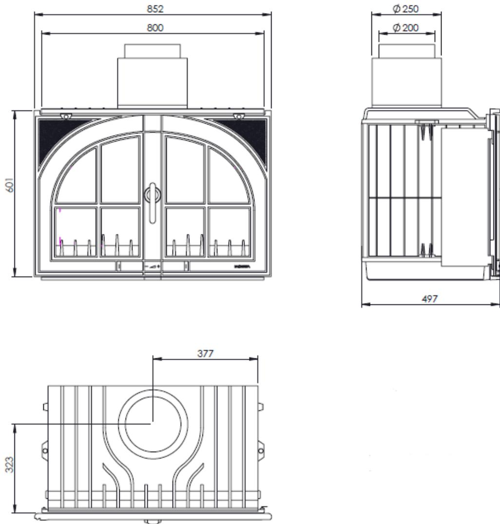
Figura n°1 - Dimensiones en mm del aparato Sara
