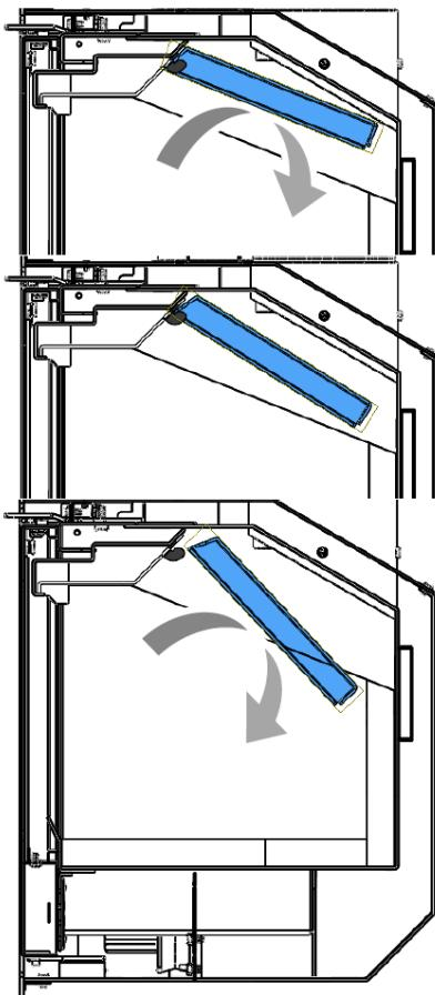
*Figure No.10 - Girar y extraer el deflecto superior de Acero*
