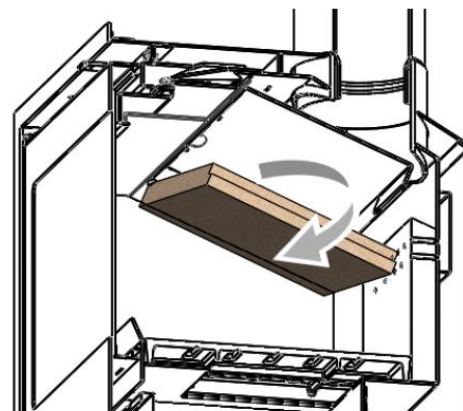
Figure No.9 - Extracción de los deflectores de vermiculita
