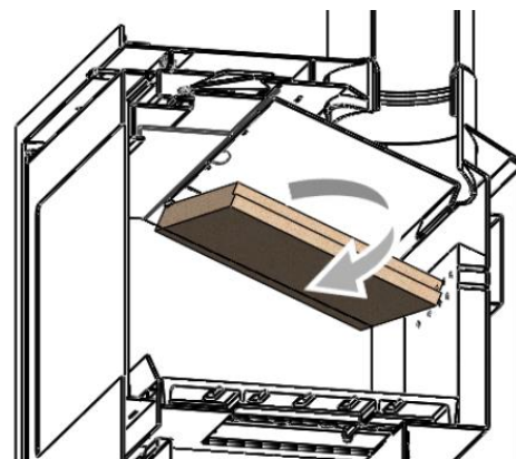
Figure No.2 - Extracción de los deflectores de vermiculita
