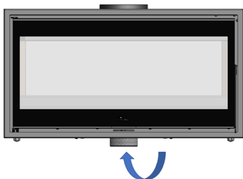
Figura n°4 - Luftführung für die Brennkammer Verona 1000
