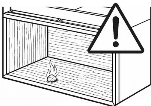
Figura n°10 - Glutpflege im Holzfach
