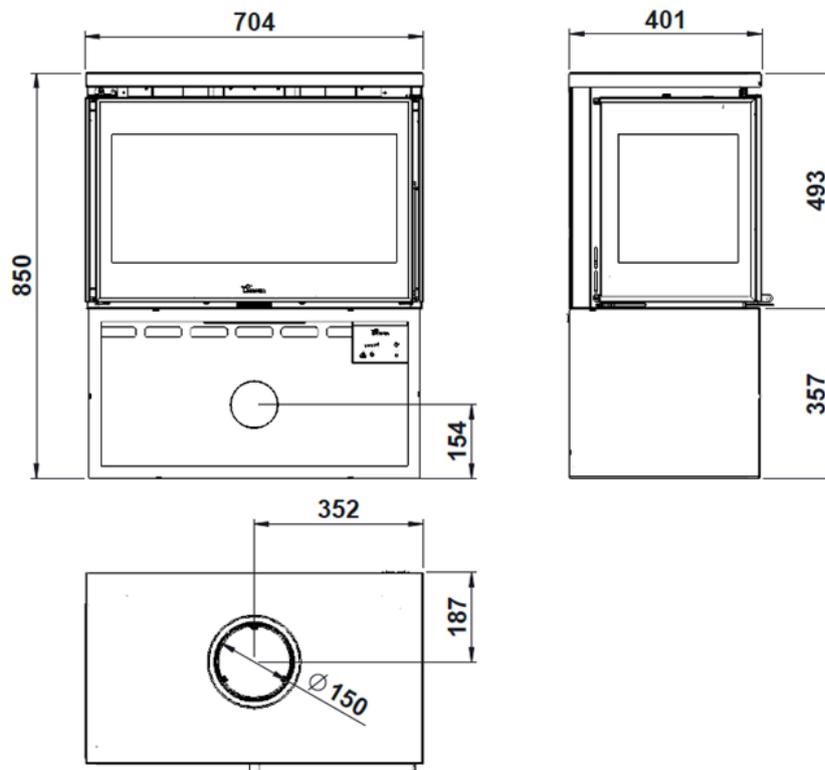
Figura n°2 - Abmessungen in mm des Produkts PARIS 700 CLID
