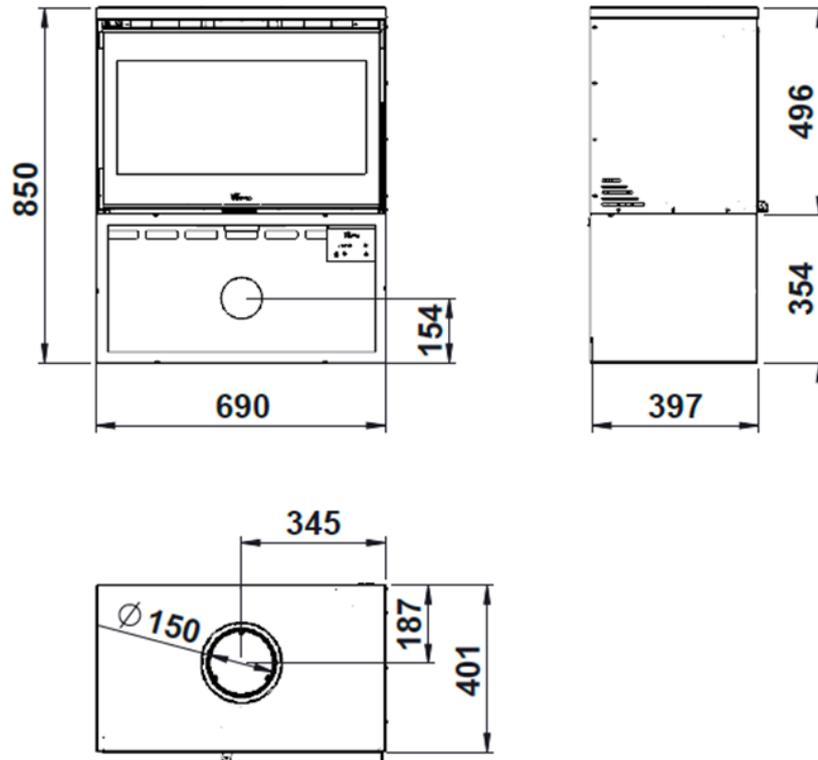
Figura n°1 - Abmessungen in mm des Produkts PARIS 700
