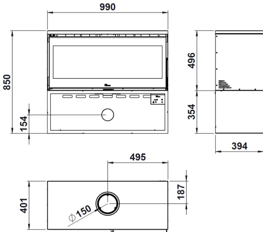
Figura n°9 - Abmessungen in mm des Produkts PARIS 1000
