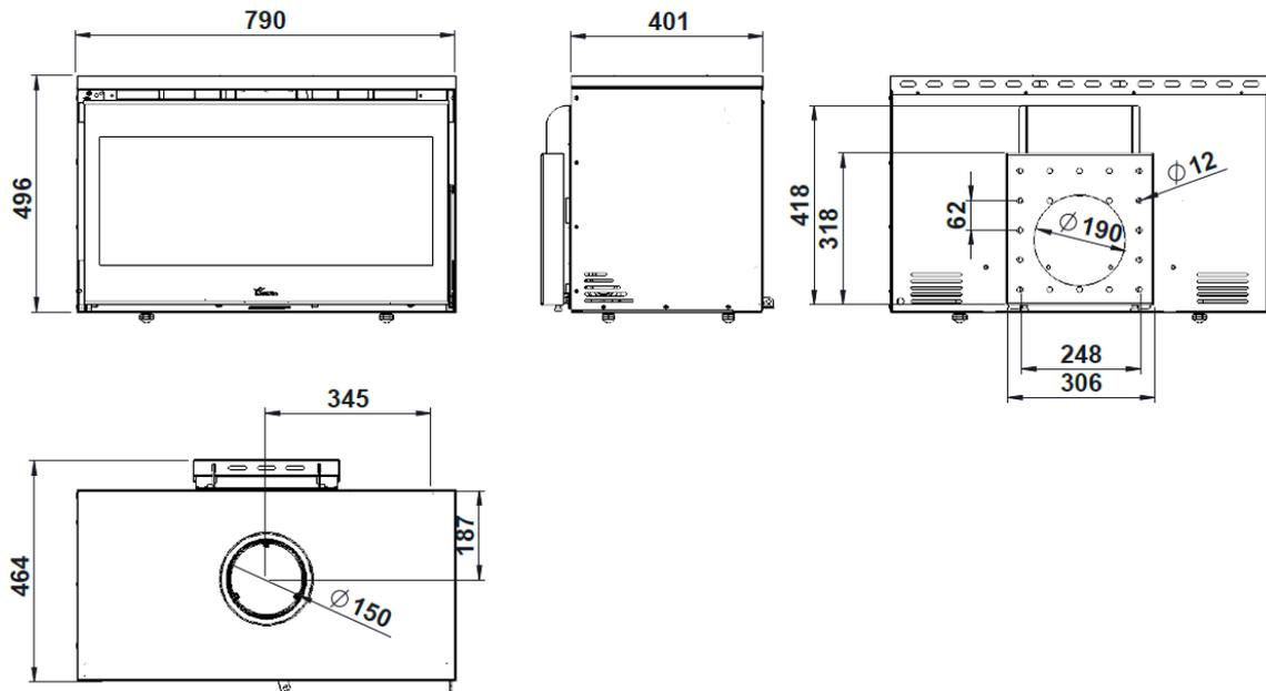
Figura n°7 - Abmessungen in mm des Produkts PARIS 800 MURAL
