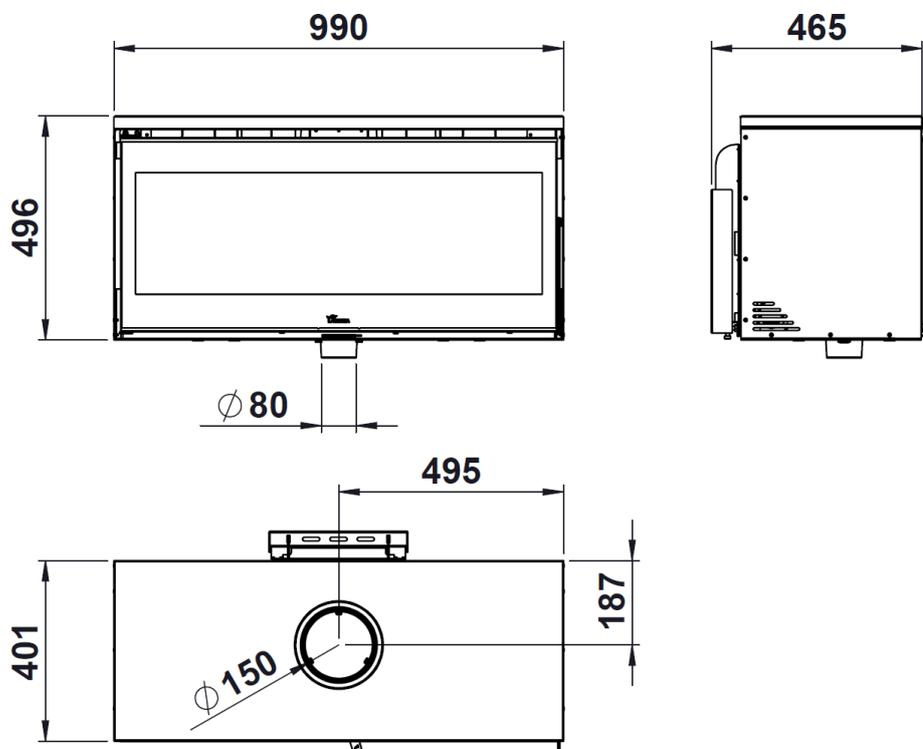
Figura n°10 - Abmessungen in mm des Produkts PARIS 1000 MURAL
