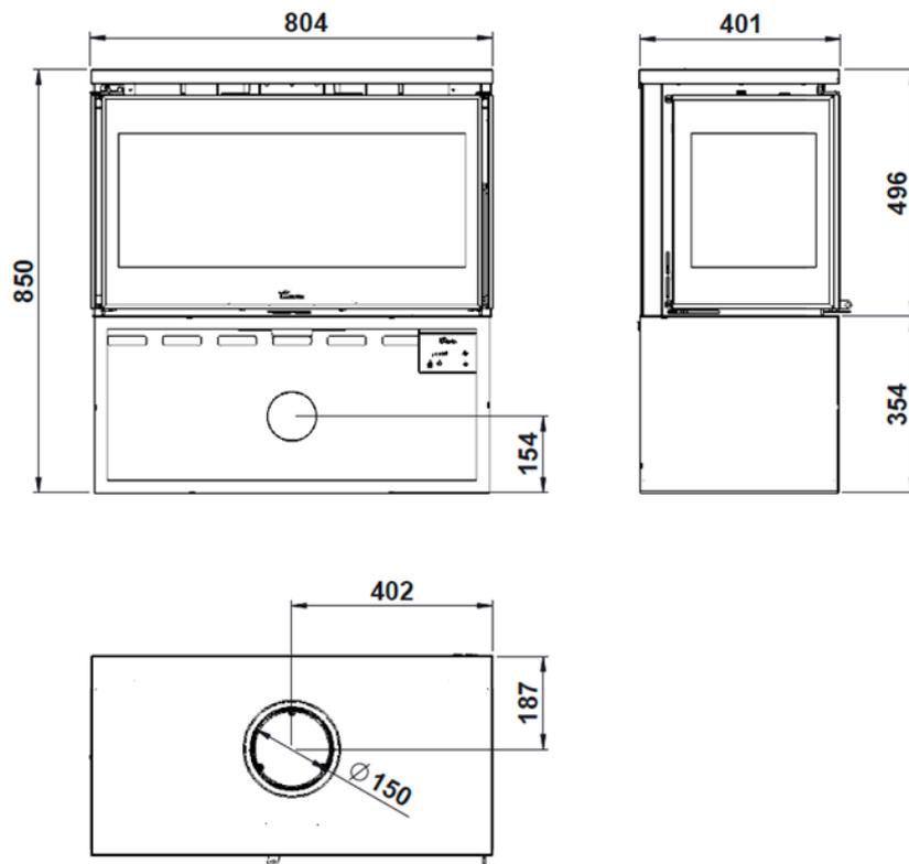
Figura n°6 - Abmessungen in mm des Produkts PARIS 800 CLID
