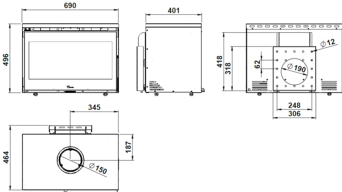
Figura n°3 - Abmessungen in mm des Produkts PARIS 700 MURAL
