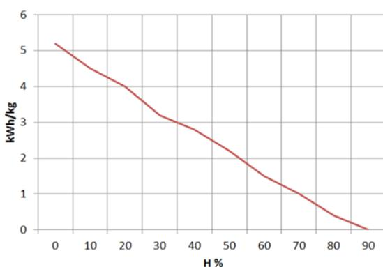
Figura n°15 - Verhältnis zwischen Feuchtigkeit und Heizwert von Brennholz.
