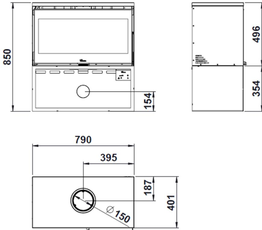
Figura n°5 - Abmessungen in mm des Produkts PARIS 800
