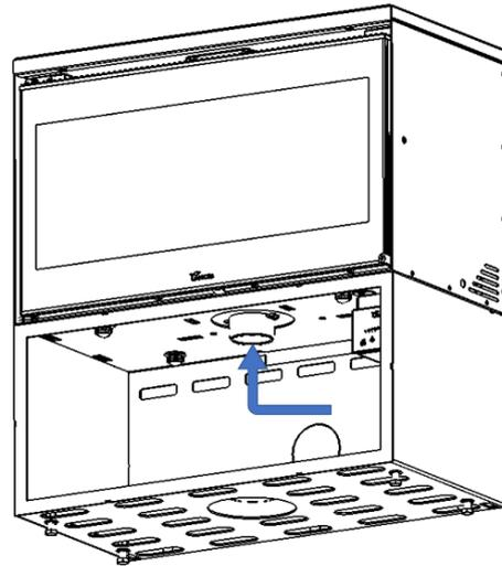
Figura n°11 - Luftführung für die Brennkammer
