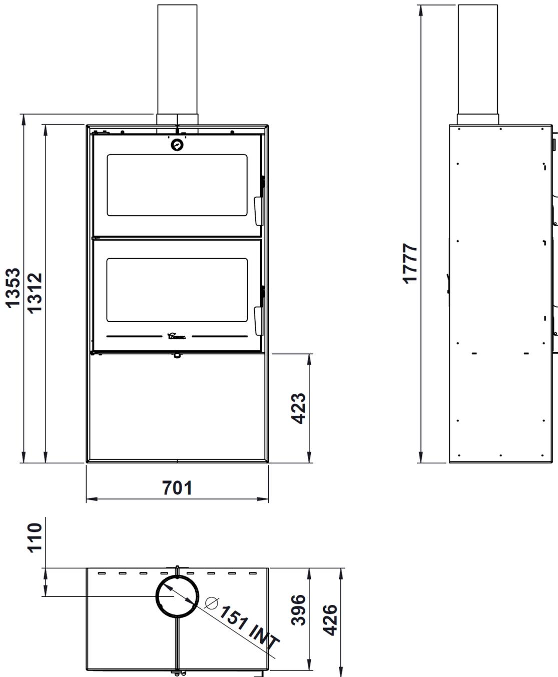
Abbildung n°1 - Abmessungen des Geräts in mm OSLO
