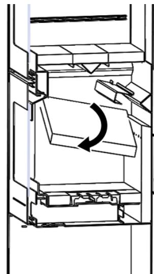
Abbildung 1 - Entfernung von Vermiculit-Prallblechen
