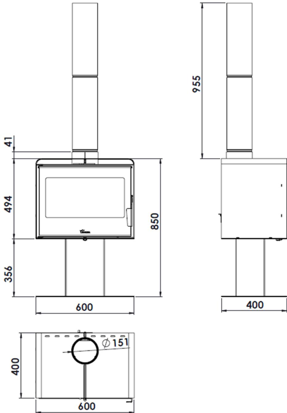
Abbildung 1 Abmessungen des Geräts in mm Ocean/Atlantic 600
