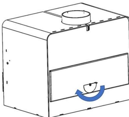
Abbildung 6 Verbrennungslufteinlassregister
