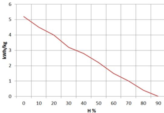
Figura n°16 - Verhältnis zwischen Feuchtigkeit und Heizwert von Brennholz.
