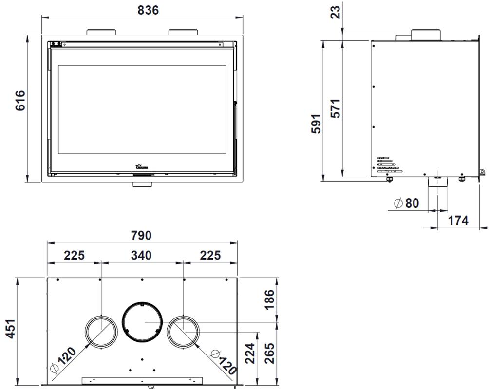
Figura n°2 - Abmessungen in mm del Produkts LOIRE 800
