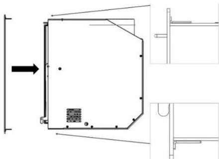
Figura n°14 - Einsetzen des Rahmens von außen
