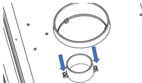
Figura n°12 - Anschrauben der Düse mit 2 Schrauben
