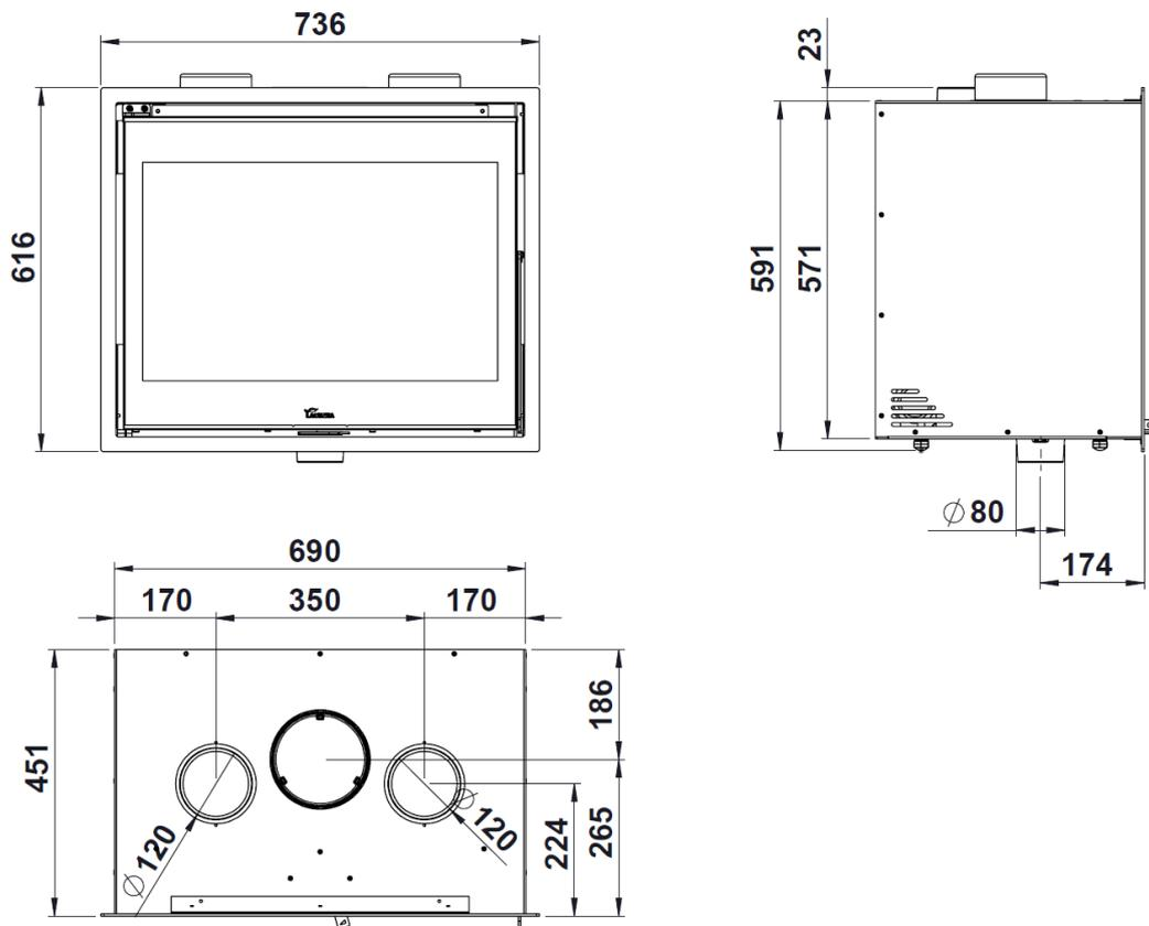
Figura n°1 - Abmessungen in mm del Produkts LOIRE 700
