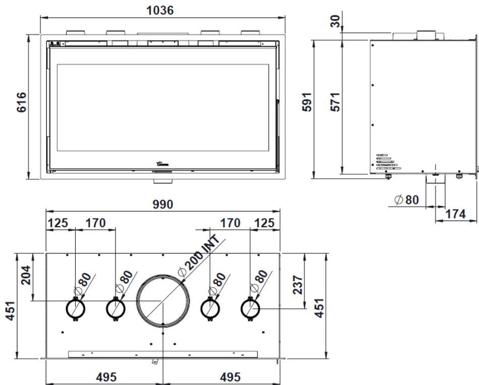
Figura n°3 - Abmessungen in mm del Produkts LOIRE 1000
