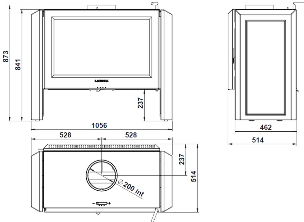
Abbildung 1 Abmessungen des Geräts in mm LEON
