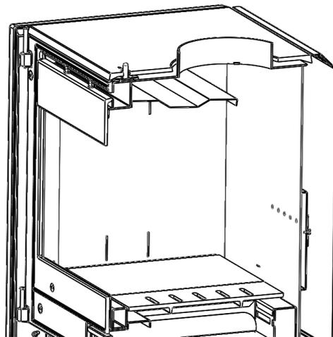
Figura n°3 - Anderes Vermiculit entfernen
