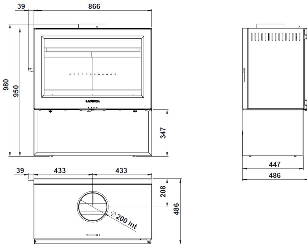
Abbildung 2 Abmessungen des Geräts in mm LUGO
