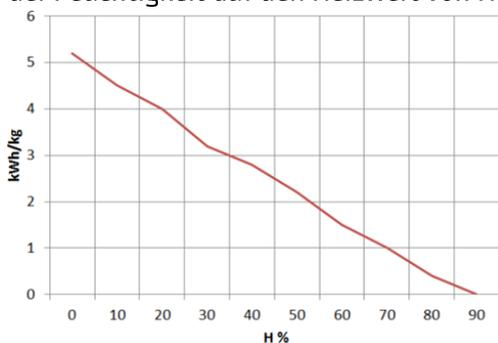
Abbildung 3 Beziehung zwischen Feuchtigkeit und Heizwert von Holz
