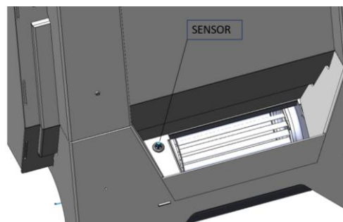
Figura n°12 - Position der Temperatursonde (SENSOR) am Turbinenluftaustritt
