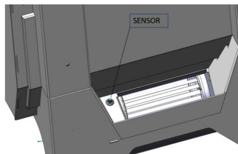
Figura n°9 - Position der Temperatursonde (SENSOR) am Turbinenluftaustritt
