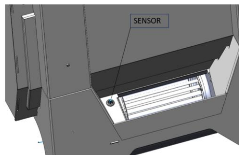
Figura n°9 - Position der Temperatursonde (SENSOR) am Turbinenluftaustritt
