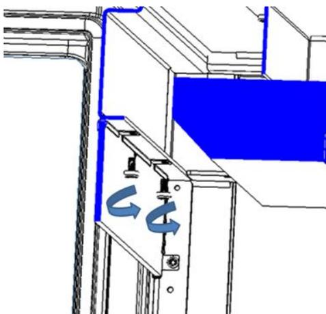
Lösen Sie die 5 Schrauben, die das "Sekundärluftkontrollglas" (6) von innen halten.
