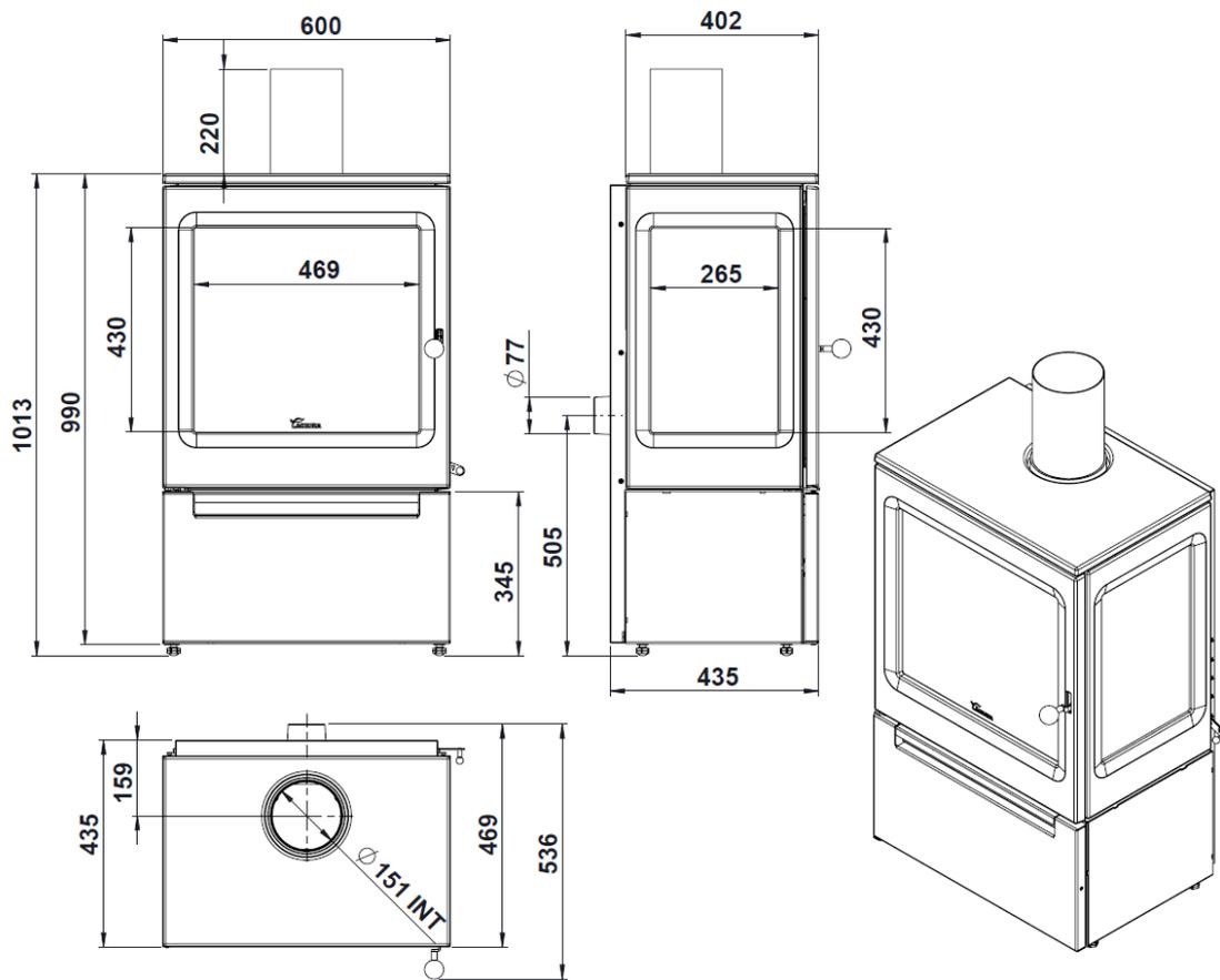
Abbildung Nr.1 - Abmessungen des Geräts in mm Garde
