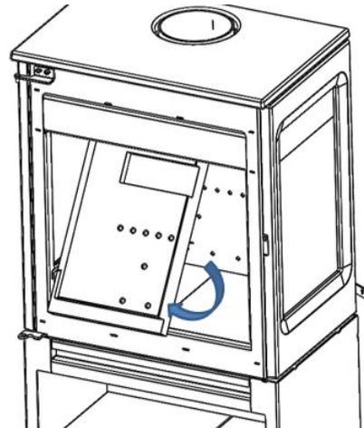
Entfernen Sie die "linke hintere Platte" (1) wie in der Abbildung gezeigt.
