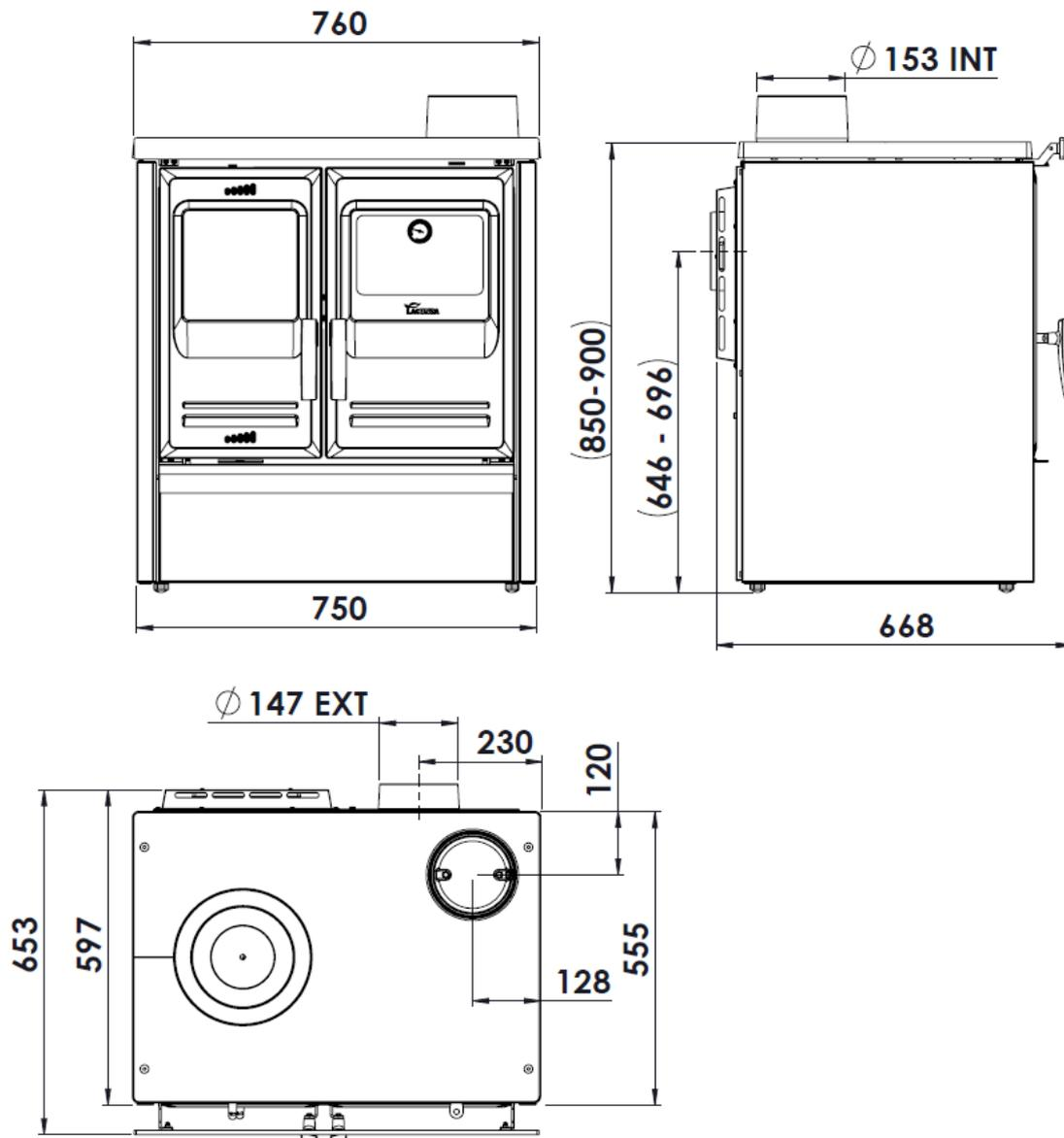
Abbildung Nr.1 - Abmessungen des Geräts in mm ETNA 5T AUSGANG OBEN UND HINTEN
