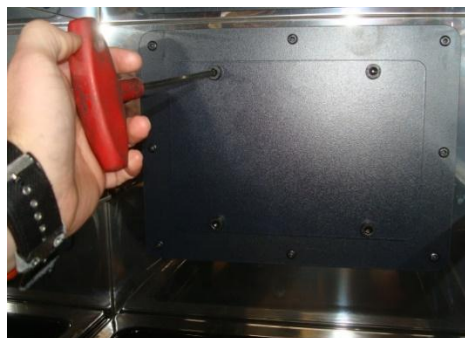
Abbildung Nr.17 - Zugang zu den Schrauben zum Entfernen des Lukendeckels.
