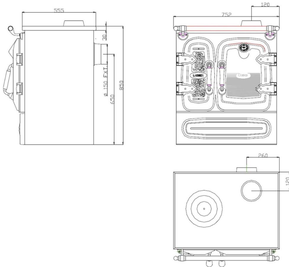
Abbildung Nr.1 - Abmessungen des Geräts in mm Clasic 5T
