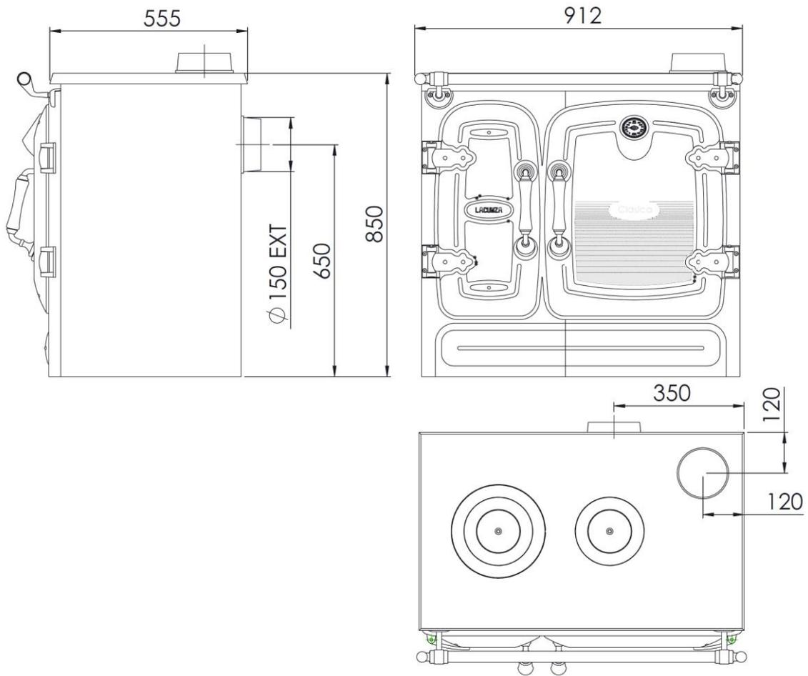
Abbildung Nr. 2 - Abmessungen des Geräts in mm Clasica 7T
