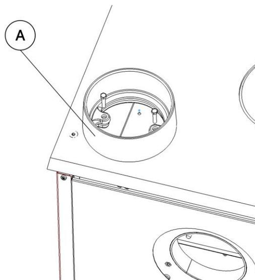
Abbildung 6 - Wir bringen den oberen Rauchabzugsflansch an.
