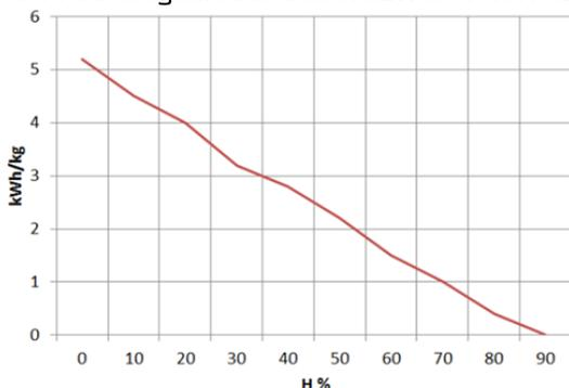
Abbildung 3 Beziehung zwischen Feuchtigkeit und Heizwert von Holz
