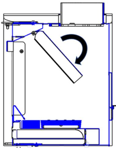
Abbildung 10 Drehen und Entfernen des oberen Stahlabweisers
