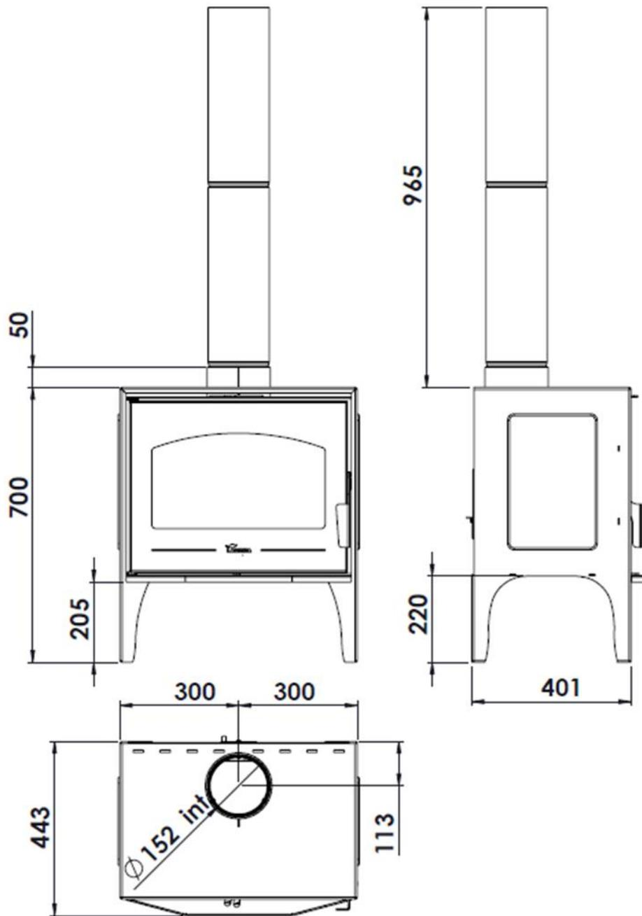
Abbildung 1 Abmessungen des Geräts in mm CALPE
