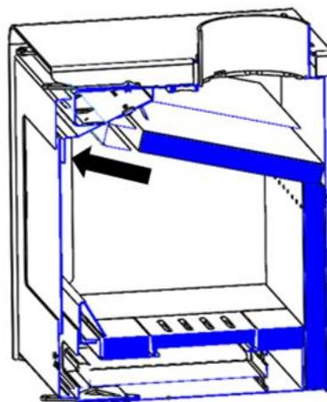
Abbildung 7 Erste Bewegung zum Lösen der Bewehrung
