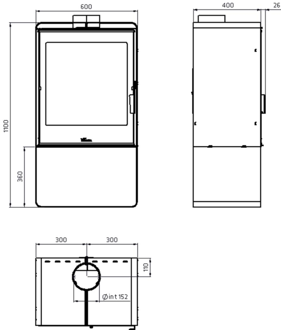
Abbildung 1 Abmessungen des Geräts in mm Atlantic 610
