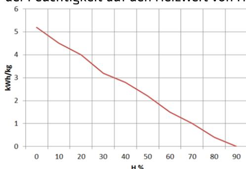
Abbildung 4 Beziehung zwischen Feuchtigkeit und Heizwert von Holz
