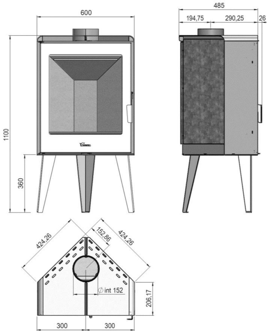
Abbildung 2 Abmessungen des Geräts in mm Atlantic 610R
