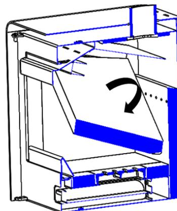
*Entfernung der Vermiculit-Schutzvorrichtungen*
