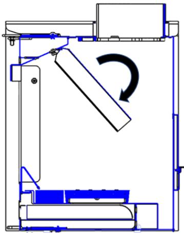
*Drehen und Entfernen des oberen Stahlabweisers*
