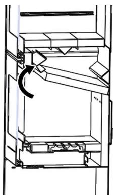
Dieses Stück muss in seiner geschlossenen Position im Schornstein platziert werden, wenn alle Werte der Norm UNE-EN 13240 erreicht werden sollen. Da dieses Stück eine wichtige zusätzliche Rückhaltung der bei der Verbrennung entstehenden Rauchgase erzeugt, erfordert seine Platzierung optimale Zug- und Brennstoffbedingungen. Wenn diese Bedingungen nicht erfüllt sind, kann sich der Benutzer dafür entscheiden, sie in die offene Position zu stellen.
