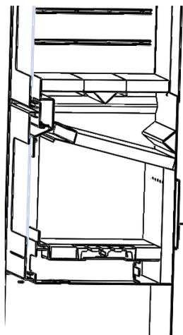
Abbildung 1 - Edelstahlverstärkung in der geschlossenen Position
