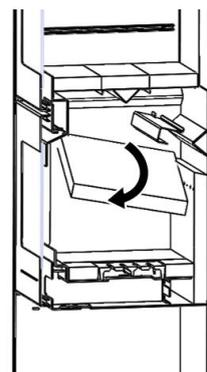
Abbildung 1 - Entfernung von Vermiculit-Prallblechen
