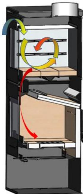
Abbildung 1 - Schema des Rauchabzugssystems
