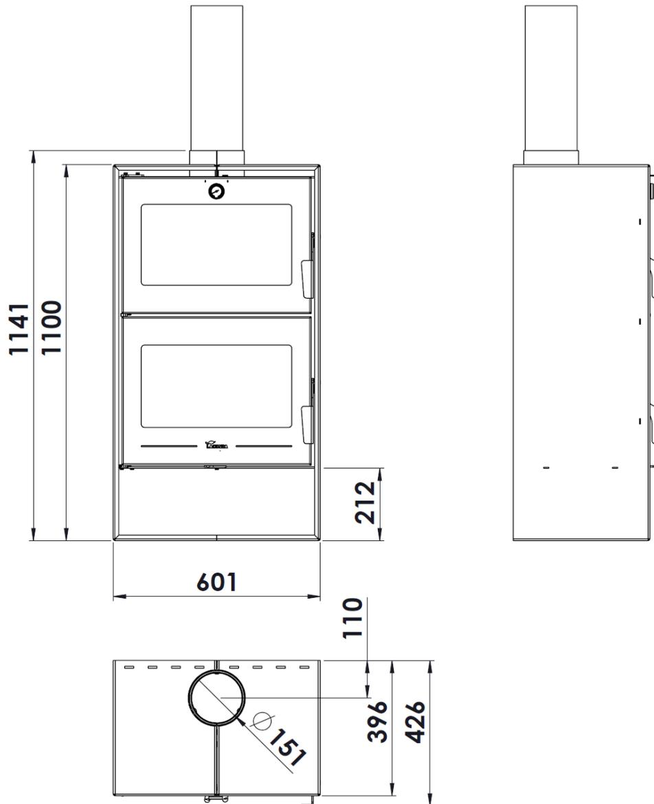
Abbildung n°1 - Abmessungen des Geräts in mm ALTEA
