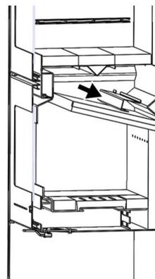
Abbildung Nr. 1 - Verstärkung auf den Vermiculit-Deflektoren
