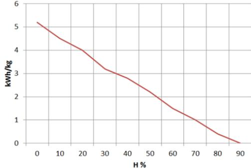
Abbildung n°1 - Beziehung zwischen Feuchtigkeit und Heizwert von Holz
