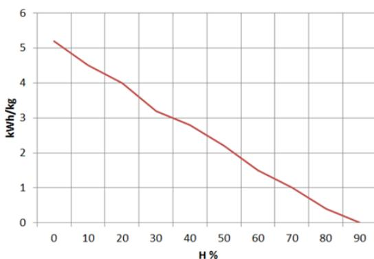
Figura n°19 - Verhältnis zwischen Feuchtigkeit und Heizwert von Brennholz.
