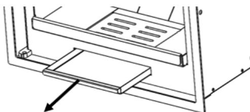
Figura n°21 - Entfernen Sie die Schublade
