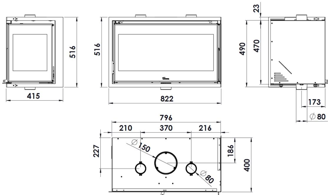
Figura n°8 - Abmessungen in mm del Produkts ADOUR 800 CLD
