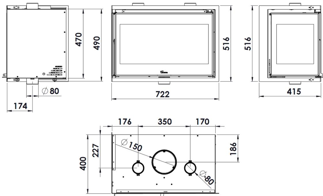
Figura n°4 - Abmessungen in mm del Produkts ADOUR 700 CLI
