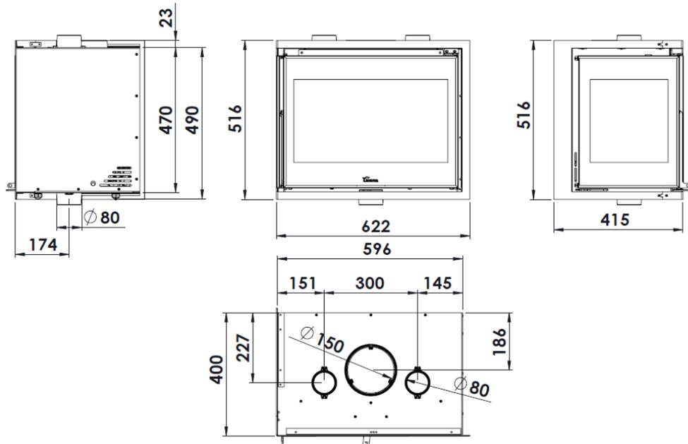
Figura n°1 - Abmessungen in mm del Produkts ADOUR 600 CLI
