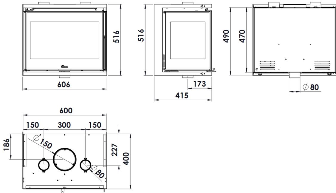
Figura n°3 - Abmessungen in mm del Produkts ADOUR 600 CLID
