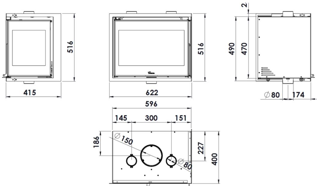
Figura n°2 - Abmessungen in mm del Produkts ADOUR 600 CLD
