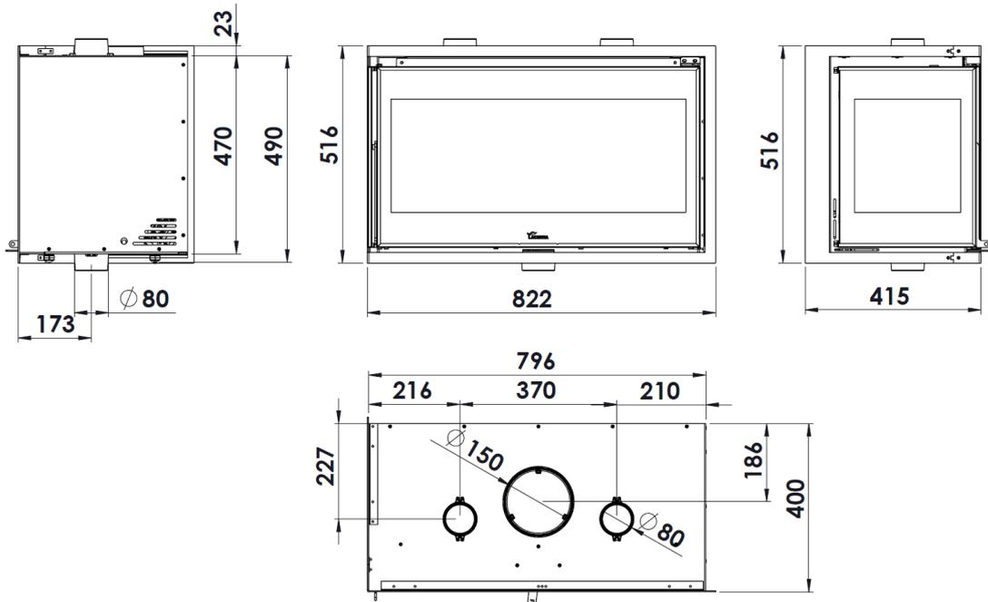
Figura n°7 - Abmessungen in mm del Produkts ADOUR 800 CLI
