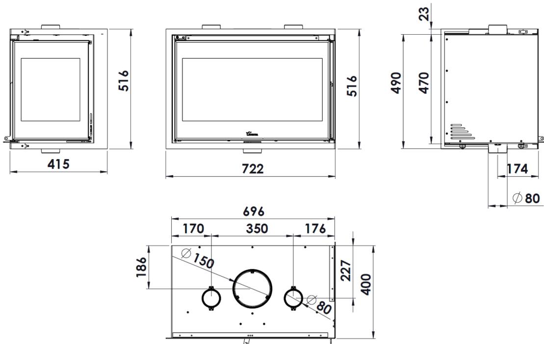
Figura n°5 - Abmessungen in mm del Produkts ADOUR 700 CLD
