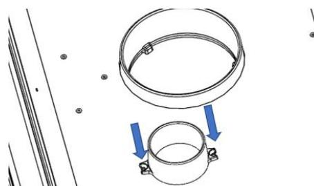
*Figura n°17 - Anschrauben der Düse mit 2 Schrauben*
