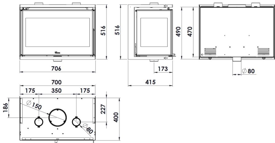
Figura n°6 - Abmessungen in mm del Produkts ADOUR 700 CLID
