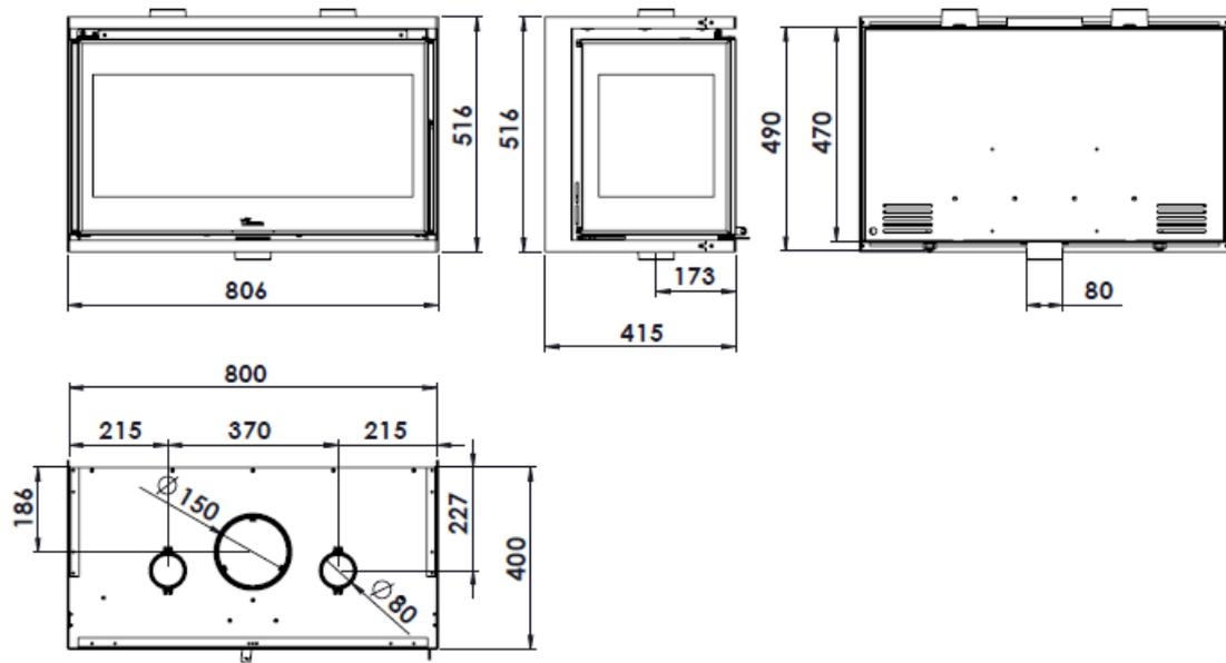
Figura n°9 - Abmessungen in mm del Produkts ADOUR 800 CLID
