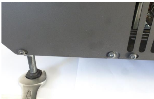
Figura n°4 - Particolare della chiave fissa da 24 per regolare i piedi
