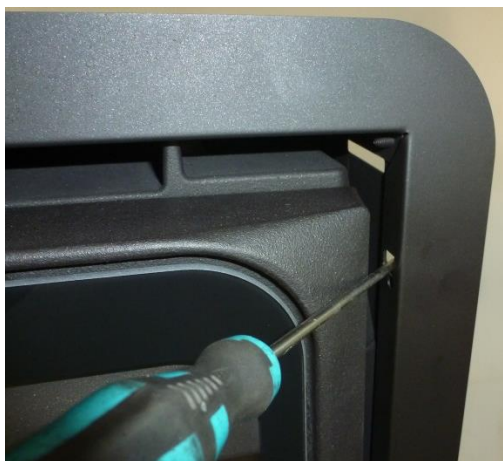
Figura n°12 - Modo di piegare le linguette
