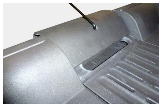
Figura nº22 - Separador deslocado para a posição de escotilha solta
