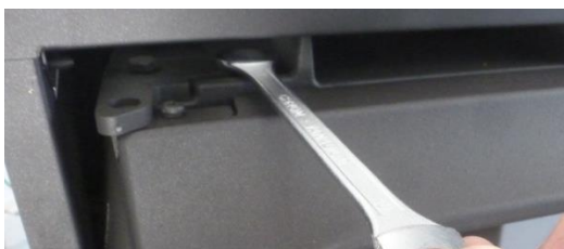
Figura nº10 - Afrouxando o suporte da porta com uma chave fixa de 10
