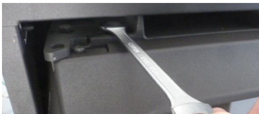
Figura nº10 - Aflojando el soporte de la puerta con llave fija de 10
