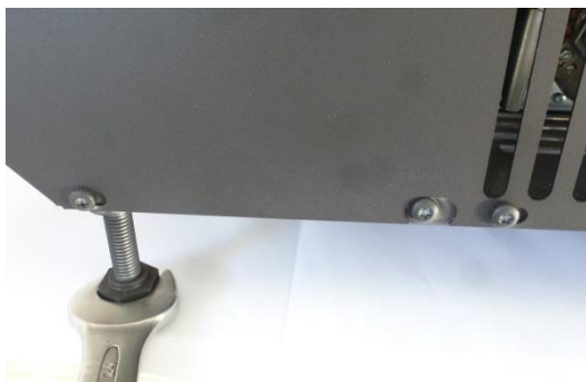
Figura nº4 - Pormenor da chave fixa de 24 para regular os pés
